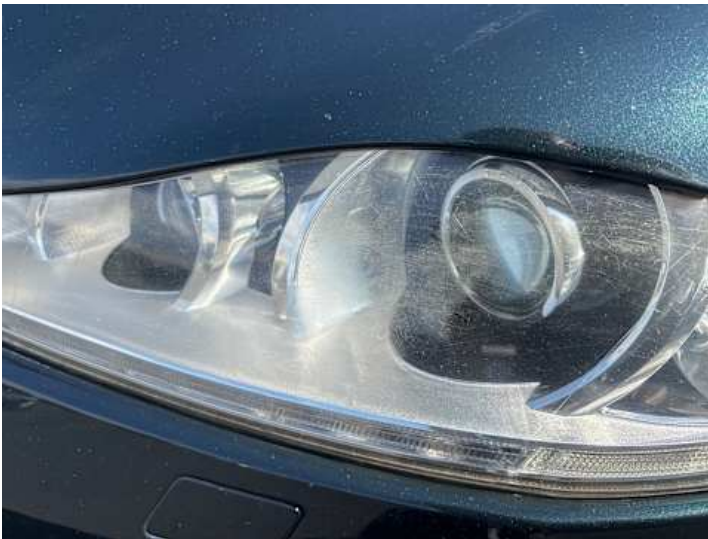
Scheinwerfer (links) (Kratzer, Blind)
