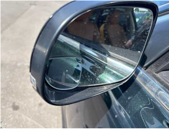
Fahrtür (Anderer Schaden): Spiegelglas aufgeklebt
