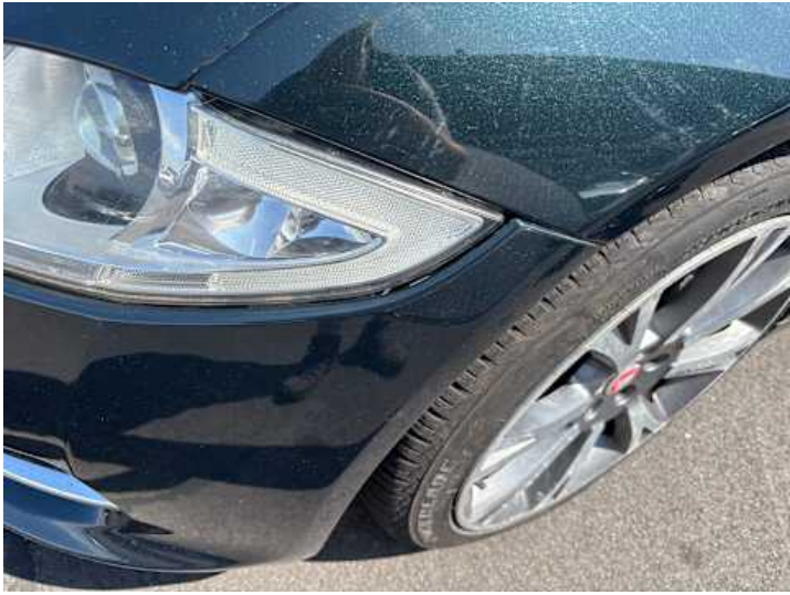
Kotflügel vorne links (Spaltmaße ungenau)
