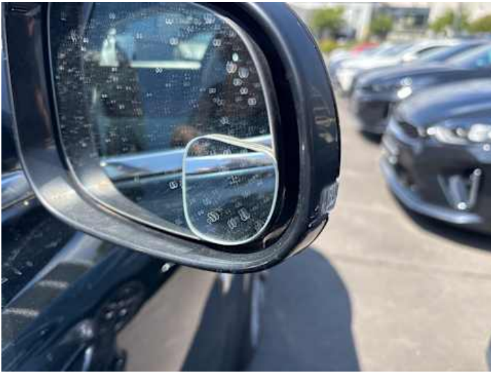
Beifahrertür (Anderer Schaden): Spiegelglas aufgeklebt
