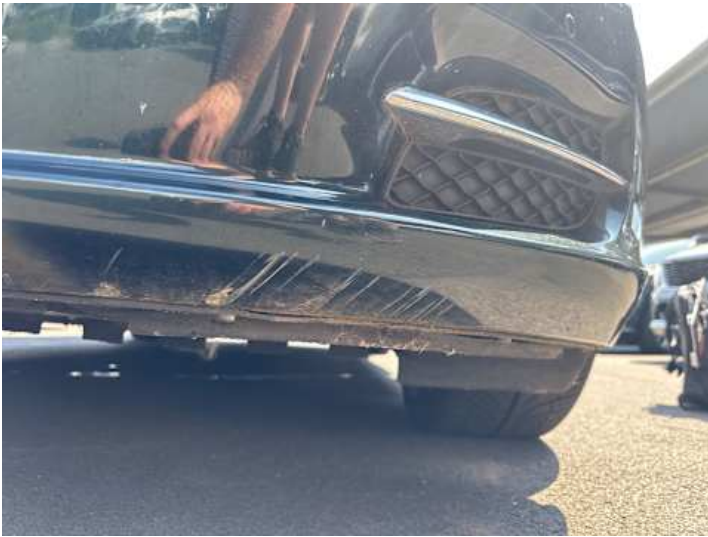
Stoßstange vorne (Kratzer, Lackschaden)
