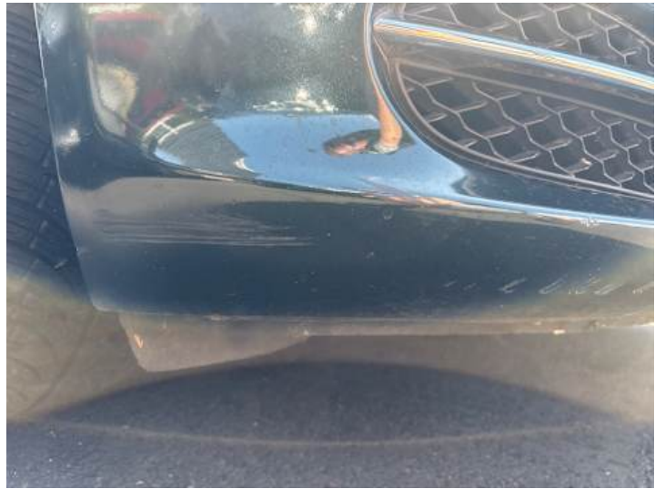
Stoßstange vorne (Kratzer, Lackschaden)
