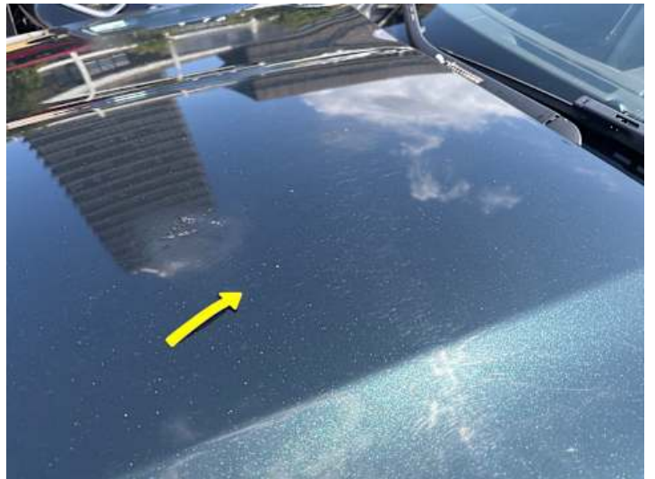
Motorhaube (Ausgeblichen/Matt, Lackschaden, Kratzer)
