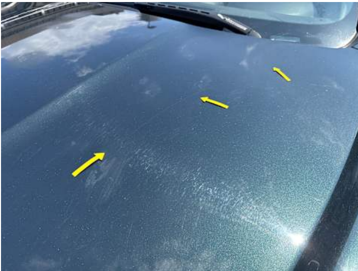
Motorhaube (Ausgeblichen/Matt, Lackschaden, Kratzer)
