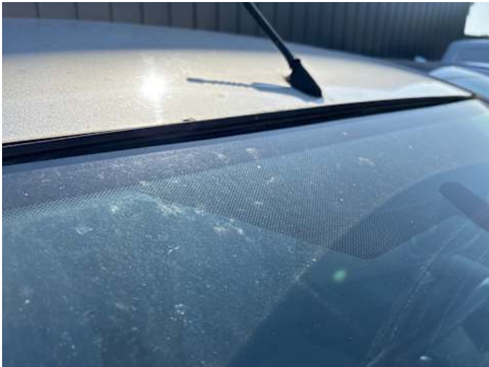
Windschutzscheibe (Anderer Schaden): Dichtung lose
