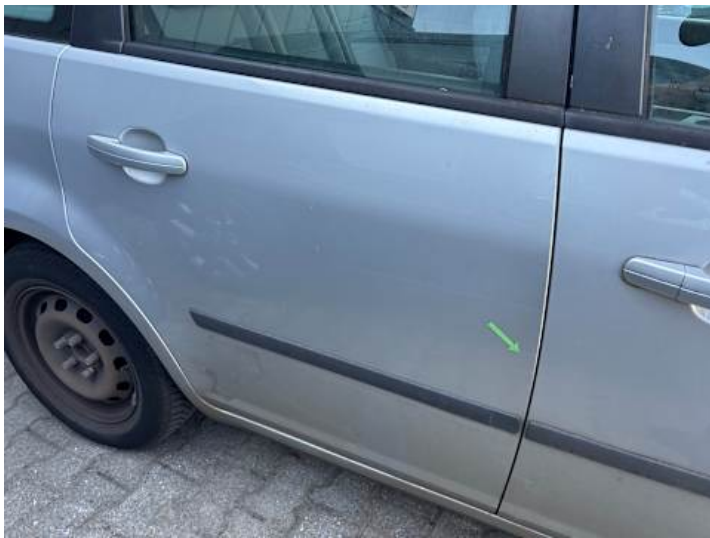
Türe hinten rechts (Lackschaden, Delle)
