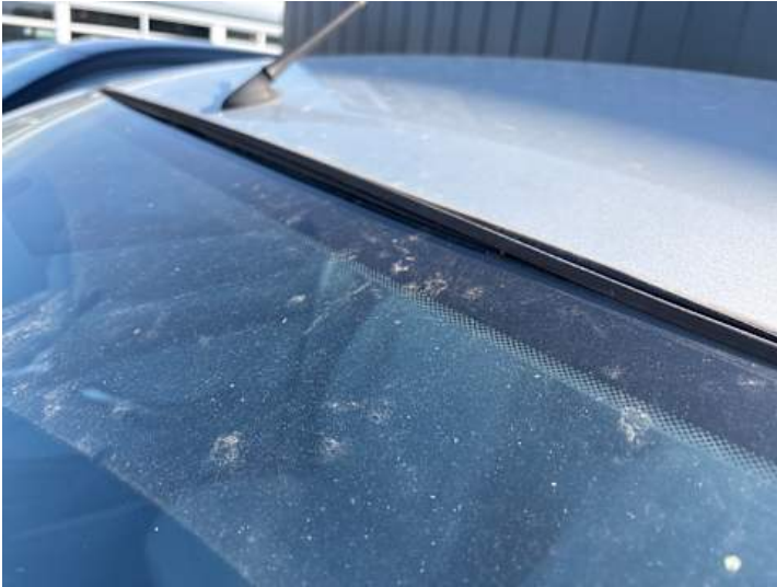
Windschutzscheibe (Anderer Schaden): Dichtung lose
