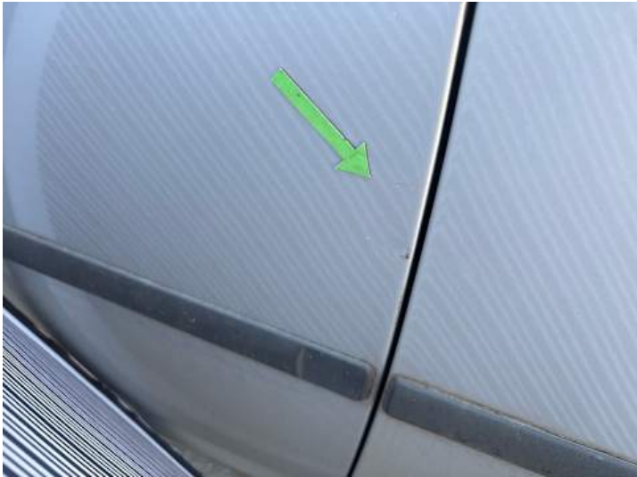
Türe hinten rechts (Lackschaden, Delle)
