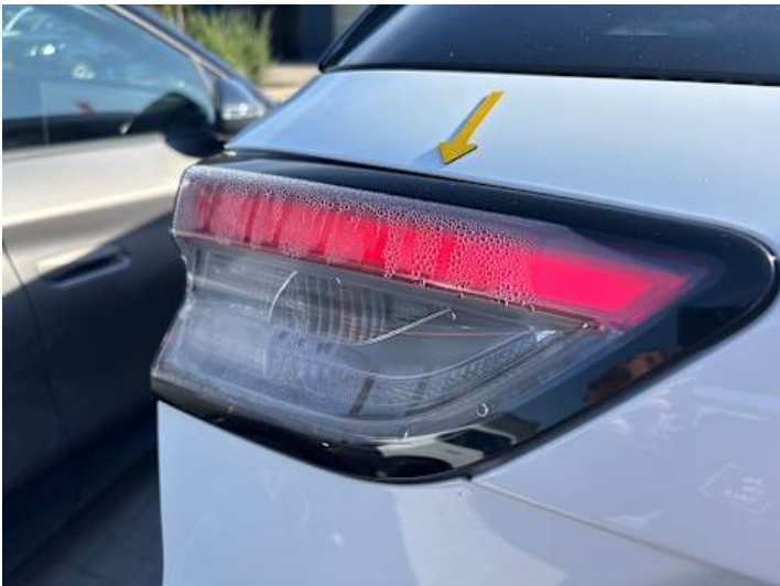
Heckklappe (Anderer Schaden): Undicht.
