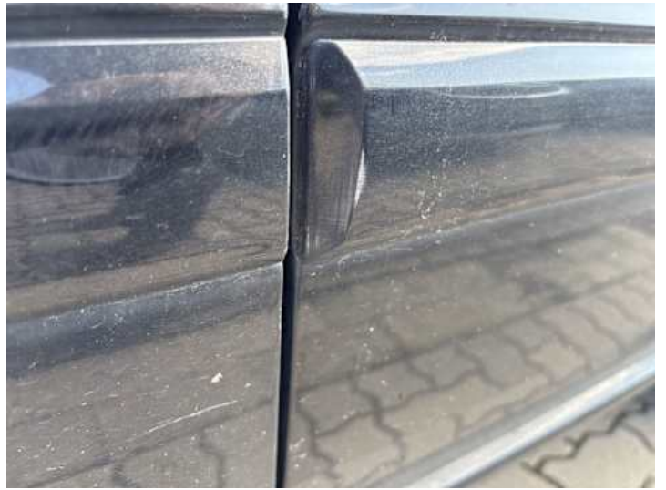
Türe hinten links (Kratzer)
