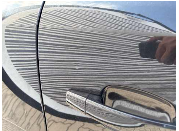
Türe hinten rechts (Kratzer, Delle)
