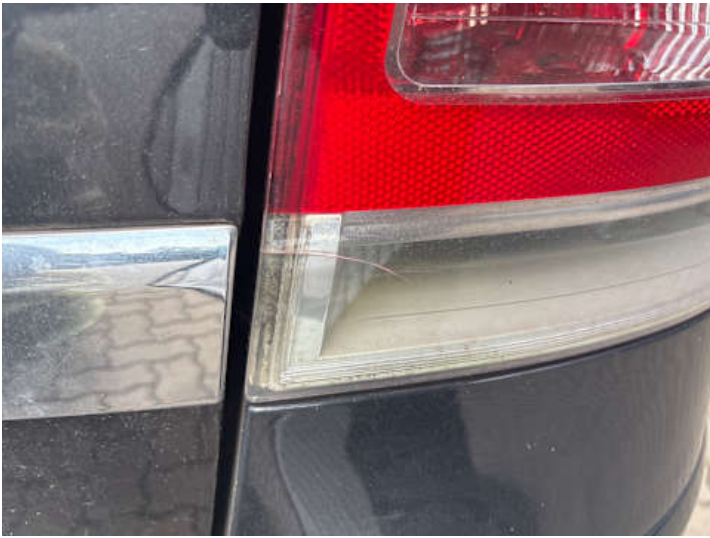
Rücklicht (rechts) (Riss/Bruch)
