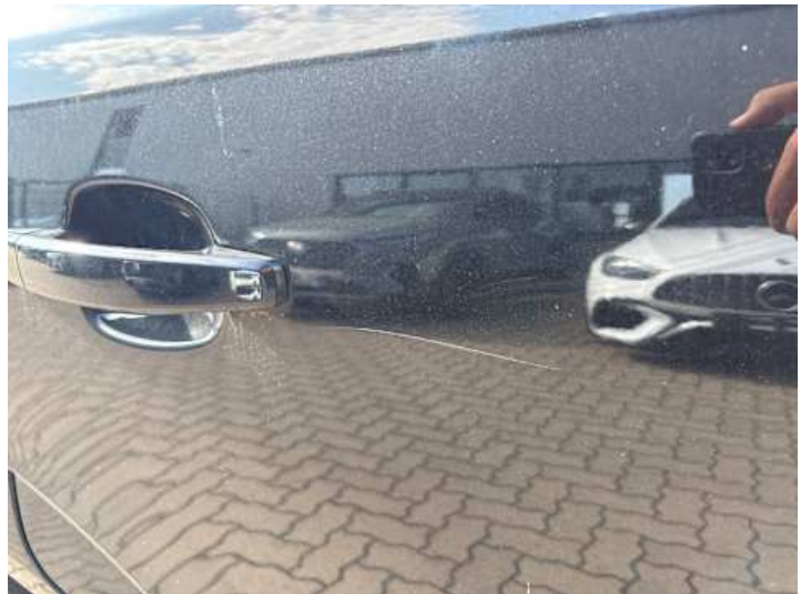
Türe hinten rechts (Kratzer, Delle)
