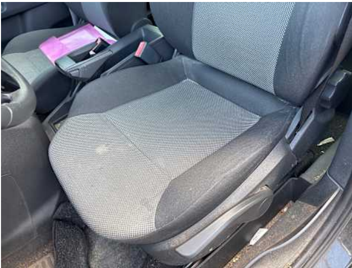
Innenraum (Verschleiß, Verschmutzung)
