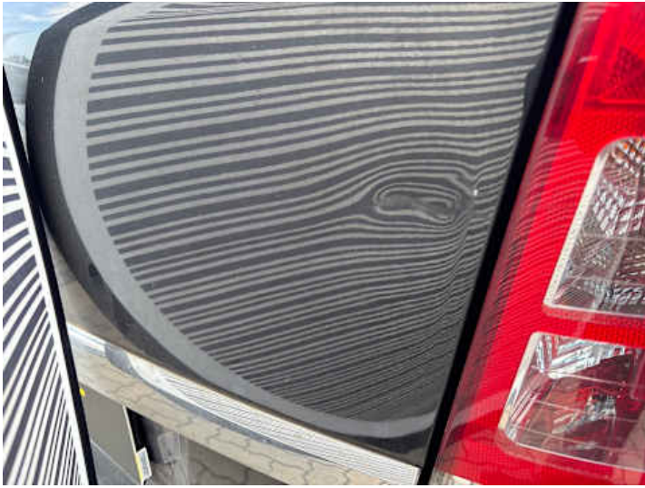
Heckklappe (Verformung, Kratzer)
