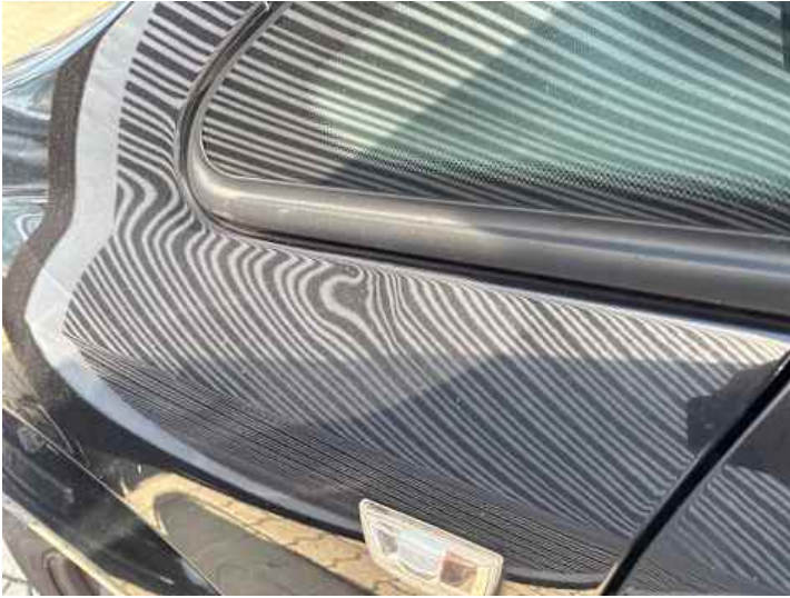
Kotflügel vorne links (Delle, Kratzer)
