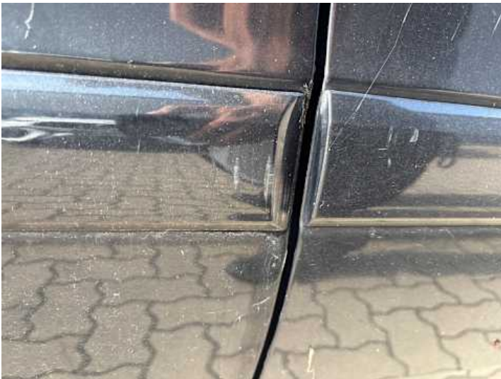
Türe hinten rechts (Kratzer, Delle)
