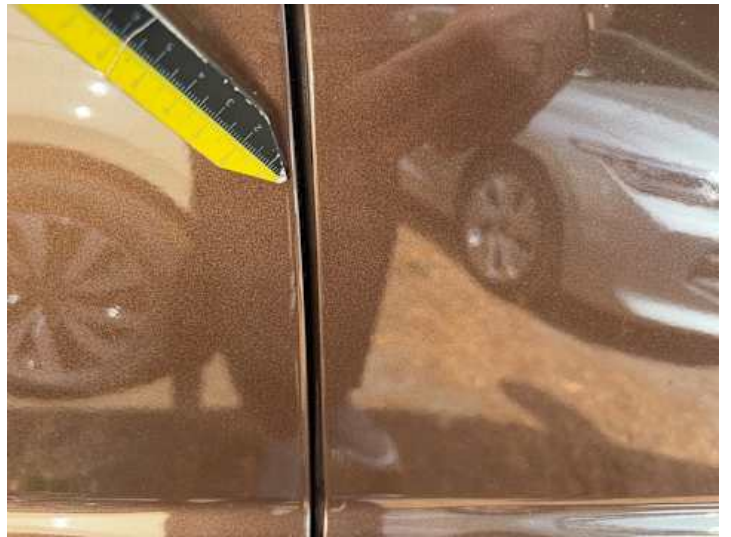
Beifahrtür (Lackschaden, Unsachgemäß instand gesetzt)
