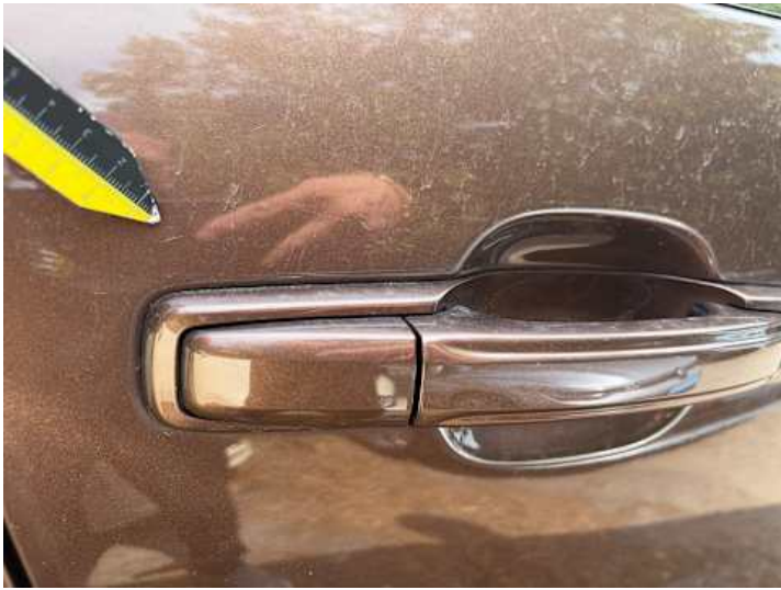
Beifahrertür (Lackschaden, Kratzer)
