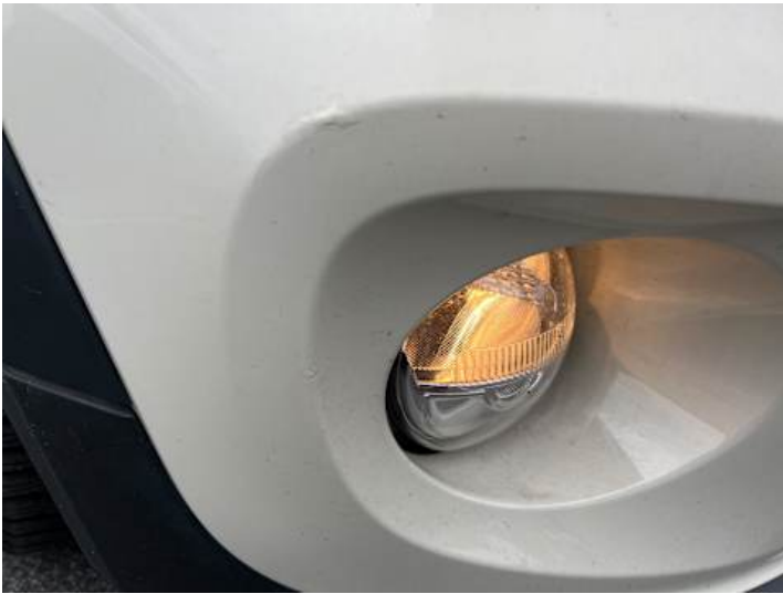
Stoßstange vorne (Kratzer, Unsachgemäß instand gesetzt)
