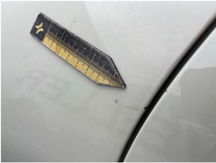
Seitenteil hinten rechts (Rost, Kratzer)
