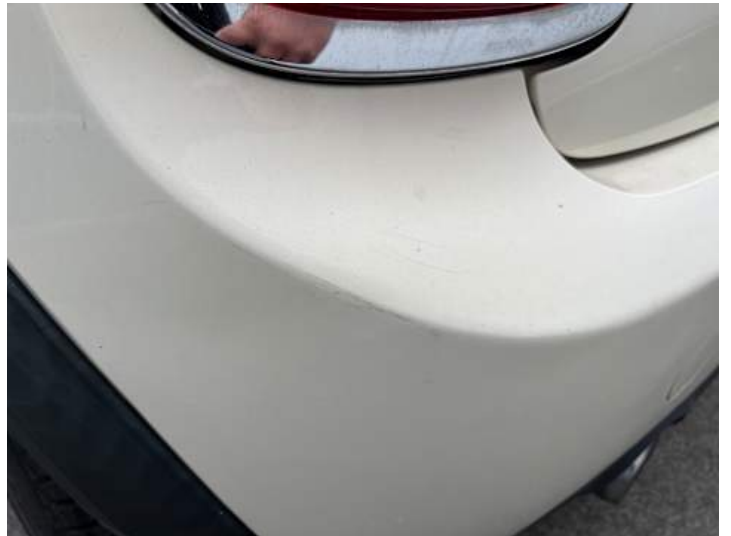
Stoßstange hinten (Verformung, Riss/Bruch)
