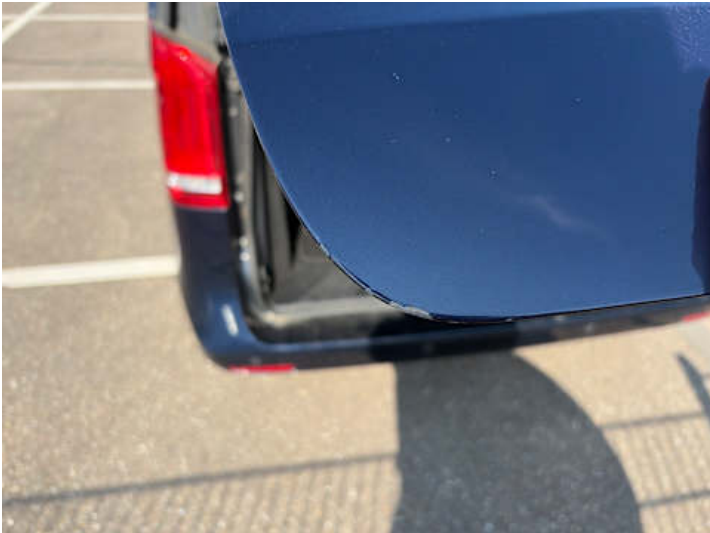
Heckklappe (Kratzer, Lackschaden, Rost)
