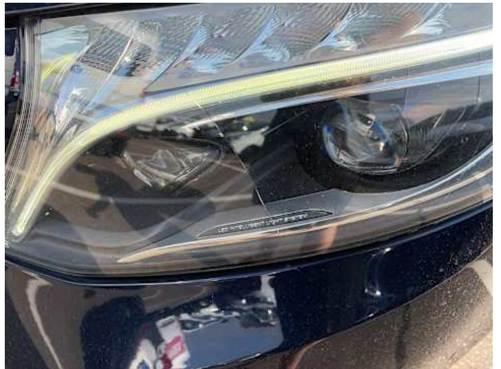
Scheinwerfer (links) (Riss/Bruch)
