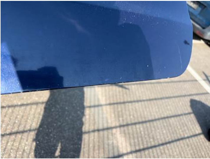
Heckklappe (Kratzer, Lackschaden, Rost)
