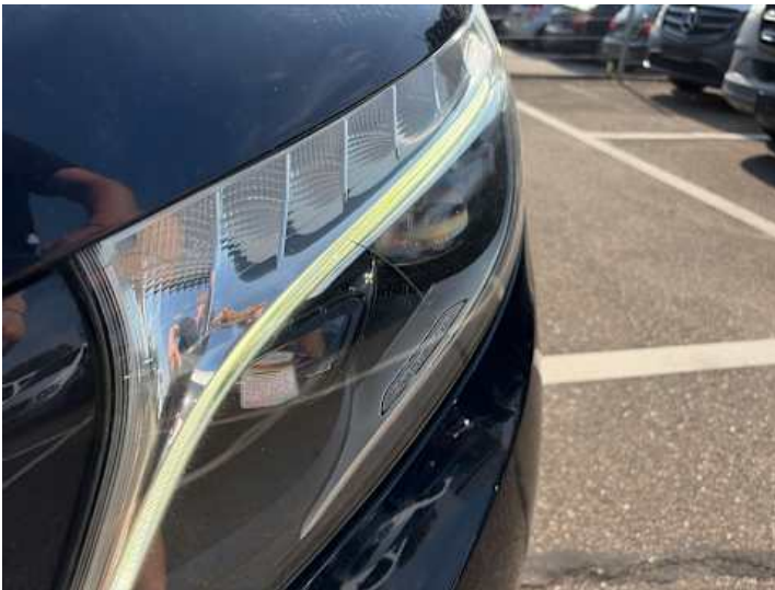
Scheinwerfer (links) (Riss/Bruch)
