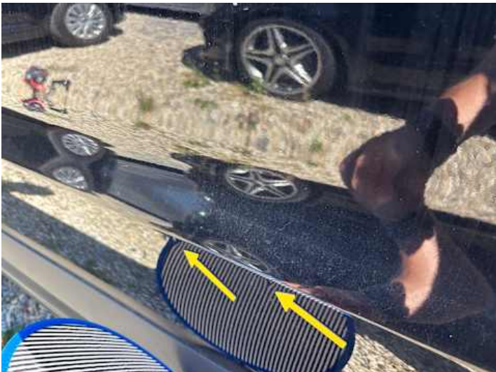
Fahrentür (Kratzer, Delle)
