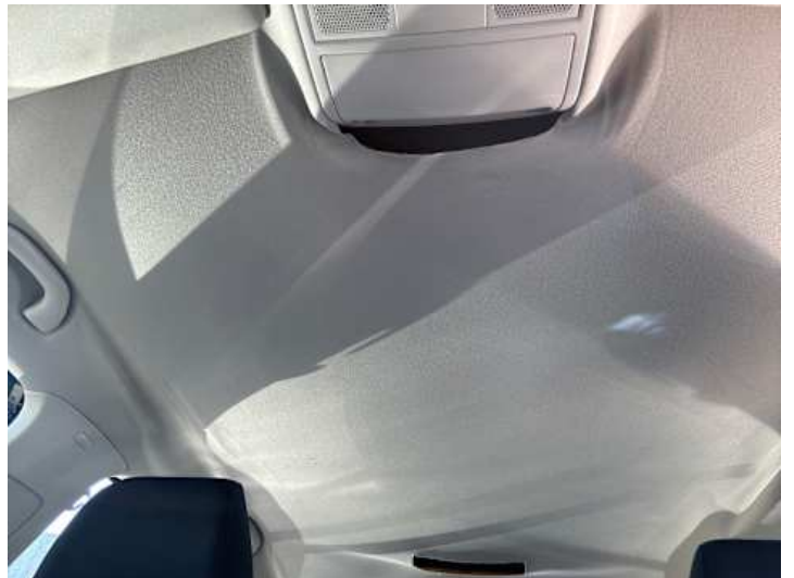
Innenraum (Anderer Schaden): Stoffablösung
