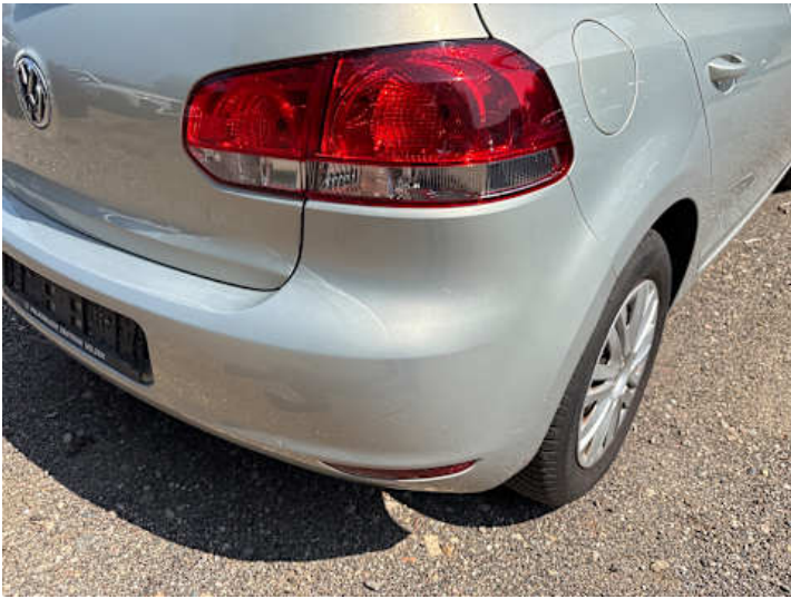
Stoßstange hinten (Lackschaden, Kratzer, Verformung)
