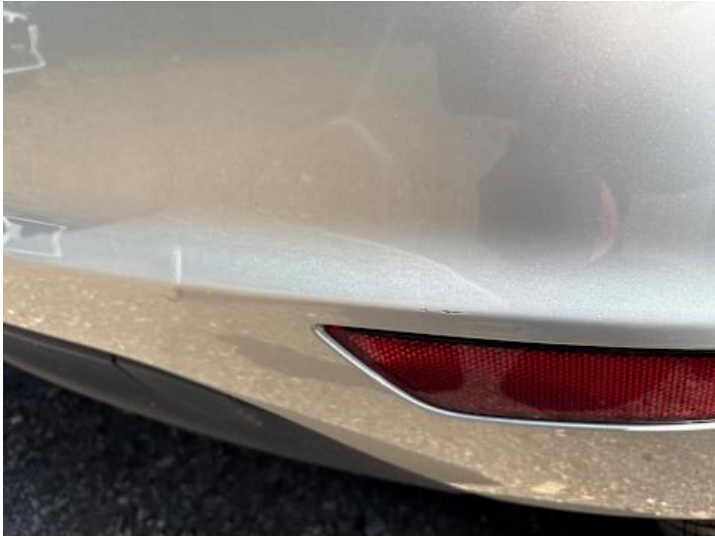
Stoßstange hinten (Lackschaden, Kratzer, Verformung)
