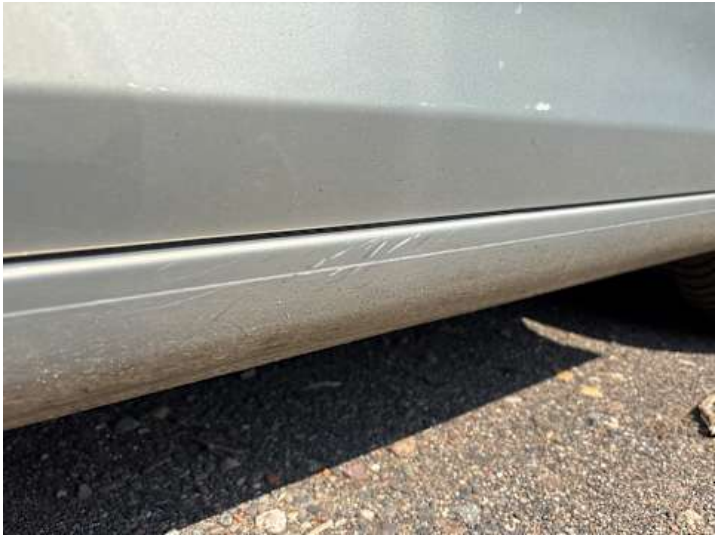
Schweller rechts (Kratzer)
