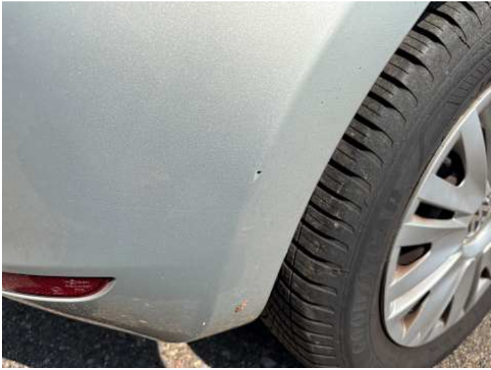
Stoßstange hinten (Lackschaden, Kratzer, Verformung)
