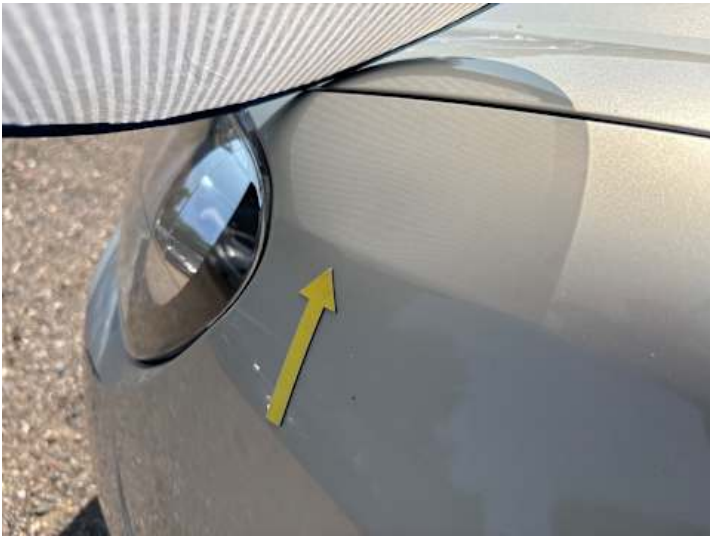
Kotflügel vorne links (Delle)
