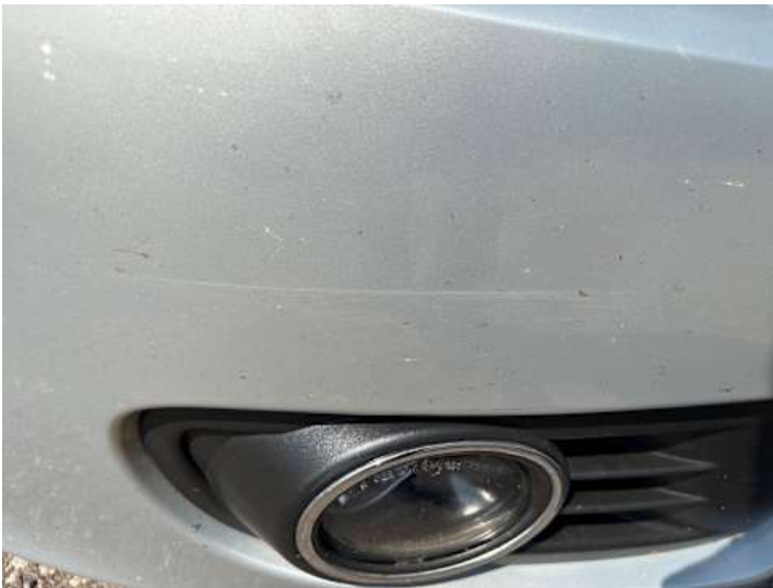
Stoßstange vorne (Anderer Schaden, Lackschaden, Riss/Bruch): Kappe fehlt
