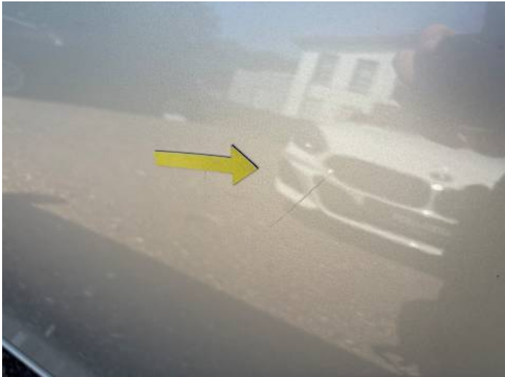
Türe hinten links (Kratzer)
