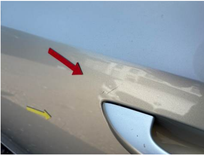
Türe hinten links (Kratzer)
