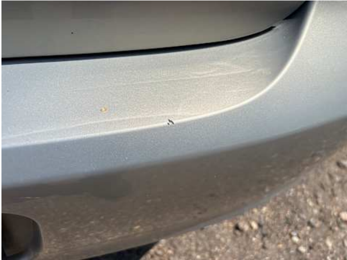
Stoßstange hinten (Lackschaden, Kratzer)
