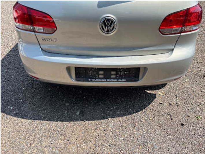
Stoßstange hinten (Lackschaden, Kratzer)
