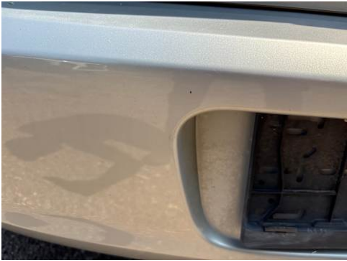
Stoßstange hinten (Lackschaden, Kratzer)
