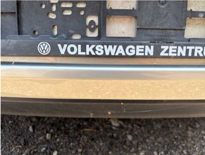
Stoßstange hinten (Lackschaden, Kratzer)
