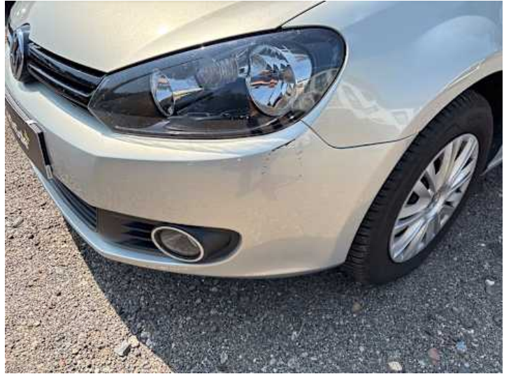
Stoßstange vorne (Lackschaden, Kratzer)
