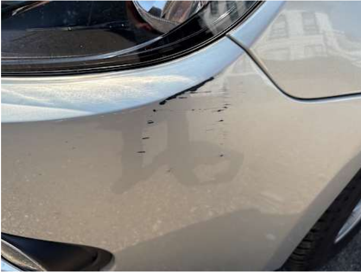
Stoßstange vorne (Lackschaden, Kratzer)
