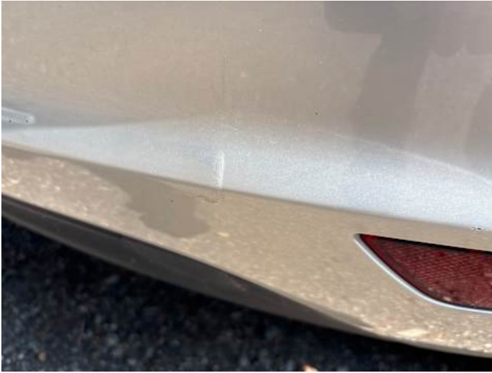
Stoßstange hinten (Lackschaden, Kratzer, Verformung)
