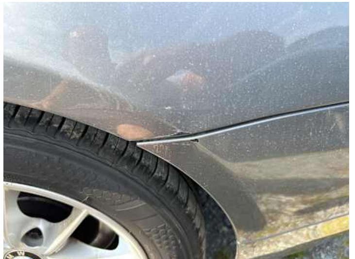
Seitenteil hinten links (Kratzer, Verformung)
