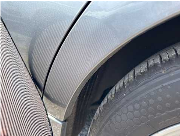
Seitenteil hinten links (Kratzer, Verformung)
