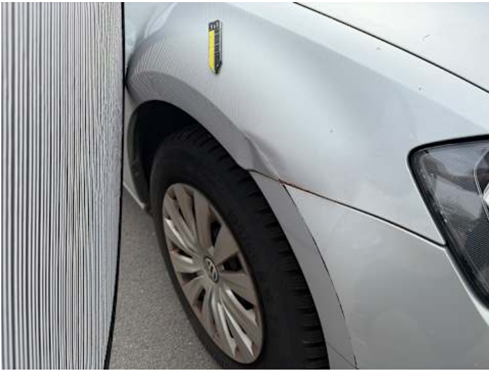
Kotflügel vorne rechts (Lackschaden, Kratzer, Rost, Verformung, Delle)
