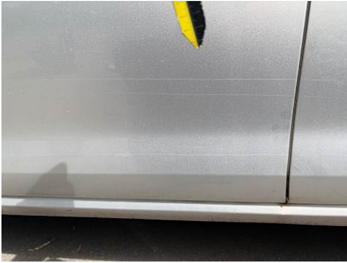
Fahrtür (Lackschaden, Kratzer)
