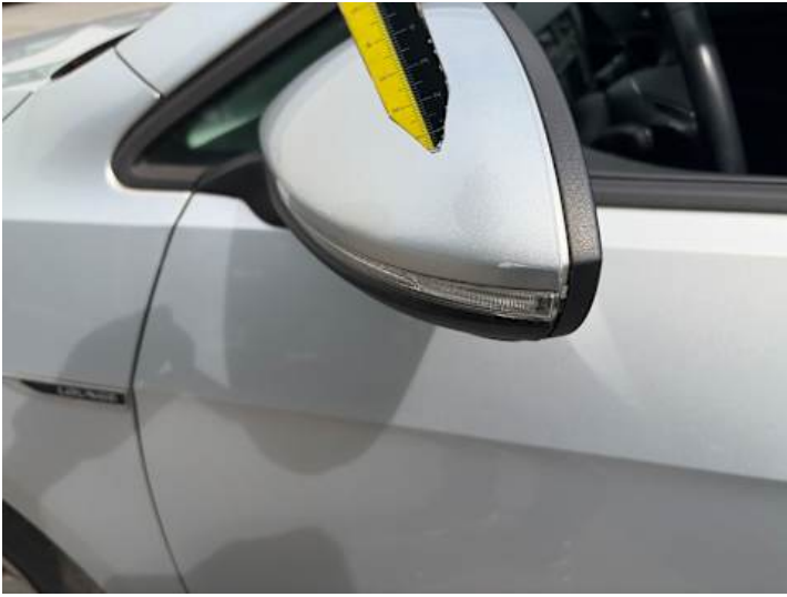
Fahrtür (Lackschaden, Kratzer)
