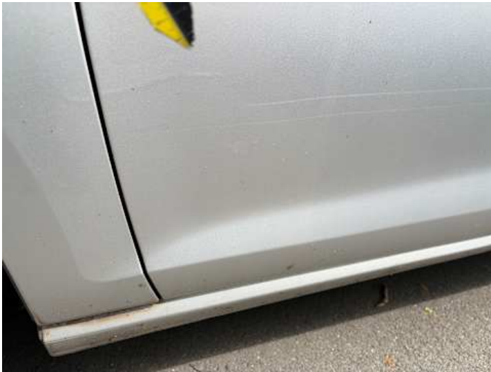
Fahrtür (Lackschaden, Kratzer)
