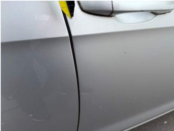
Beifahrertür (Lackschaden, Kratzer)
