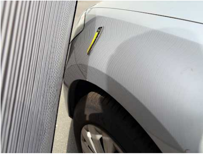
Kotflügel vorne links (Delle, Verformung)
