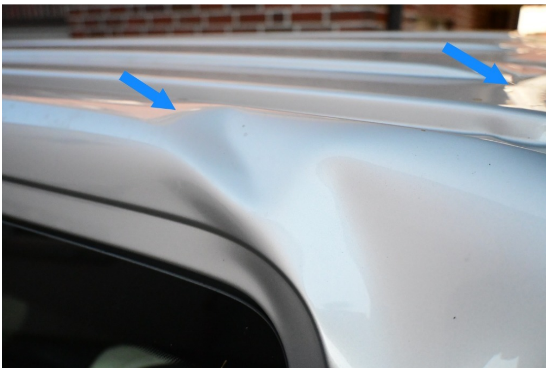
Bild 10 - Dach und Dachholm links deformiert
