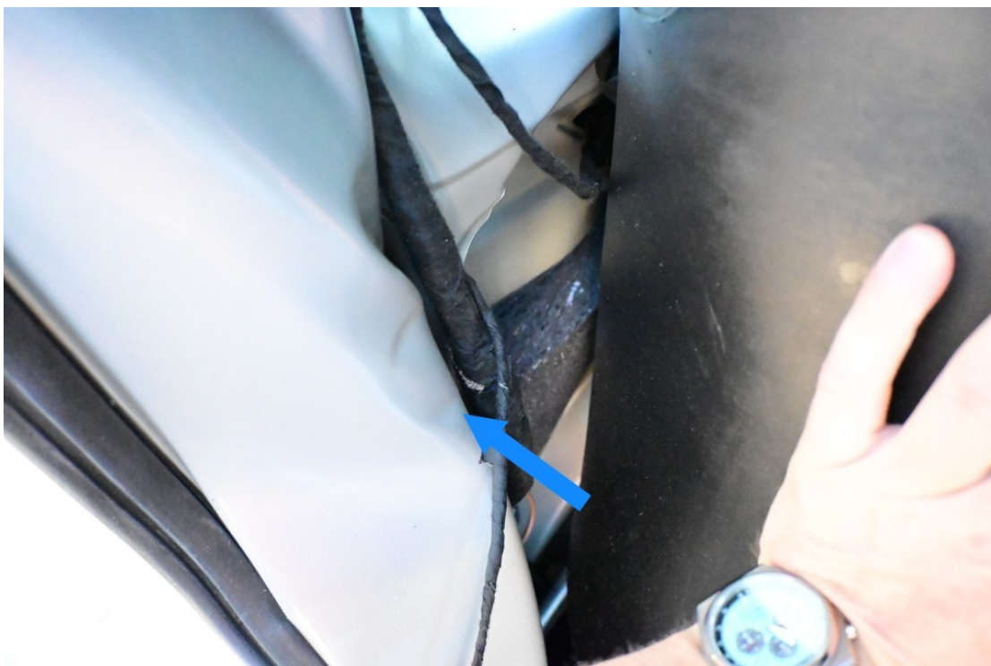
Bild 15 - Ecksäule hinten links deformiert
