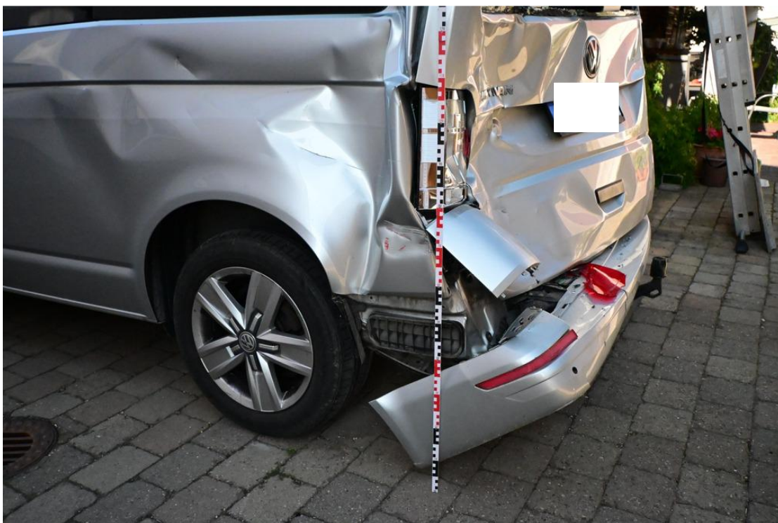
Bild 7 - Höhenmaß im Schadenbereich
