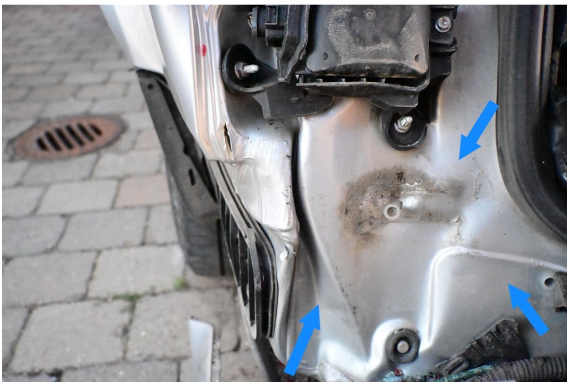
Bild 18 - Heckabschlussblech deformiert und verschrammt
