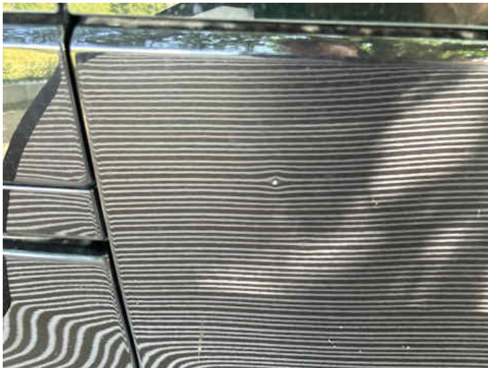
Türe hinten rechts (Delle)
