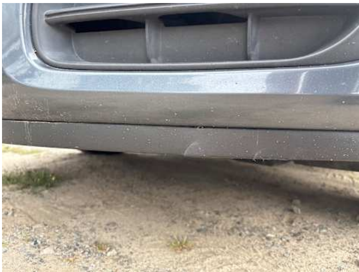
Stoßstange vorne (Riss/Bruch)
