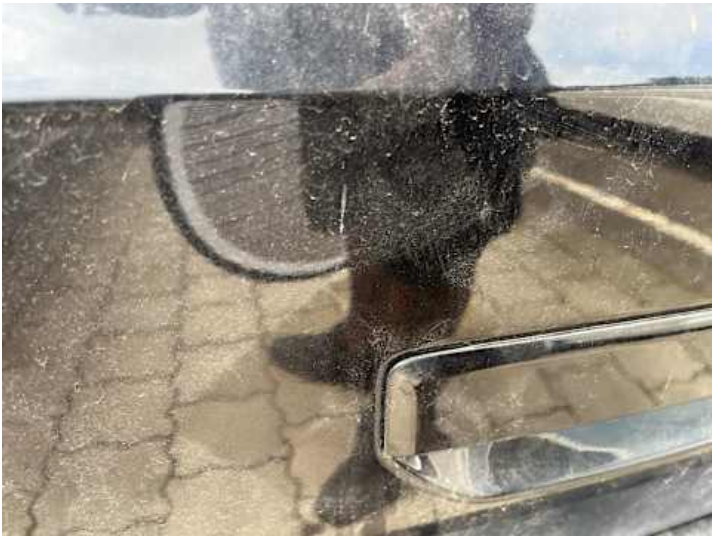
Heckklappe (Kratzer, Lackschaden)
