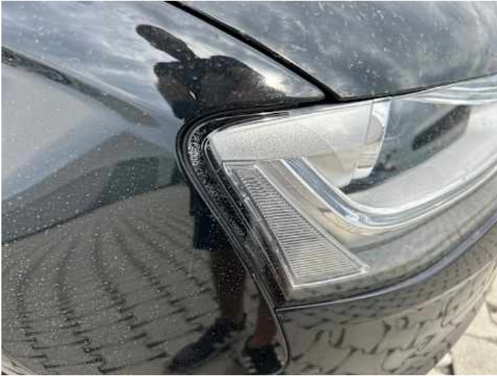
Scheinwerfer (rechts) (Riss/Bruch)
