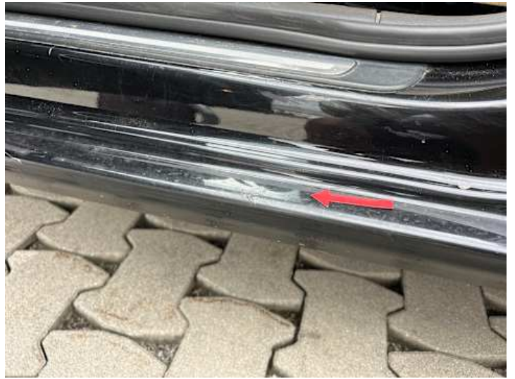
Schweller links (Rost)
