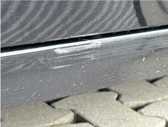
Schweller links (Kratzer, Verformung)
