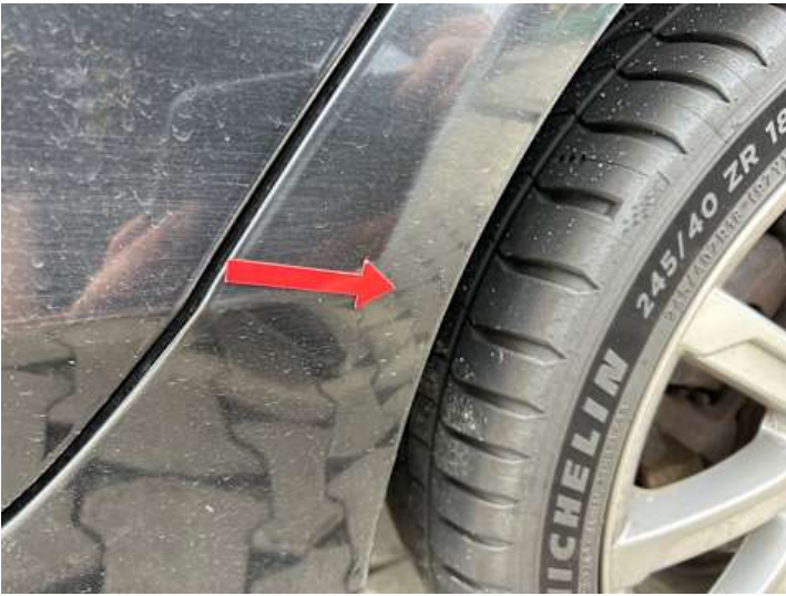
Seitenteil hinten links (Rost)
