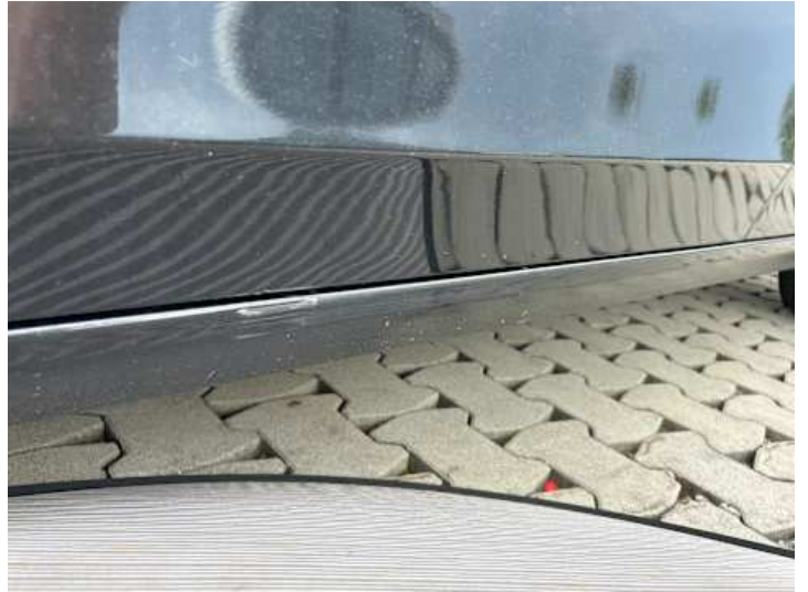
Schweller links (Kratzer, Verformung)
