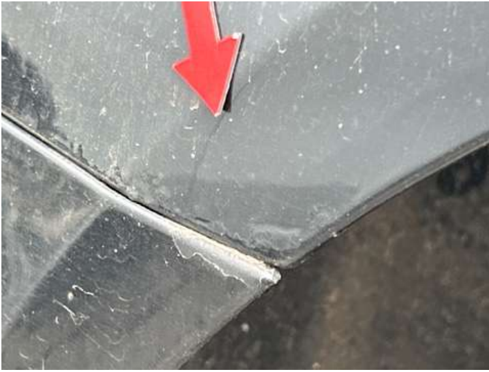
Seitenteil hinten rechts (Rost)
