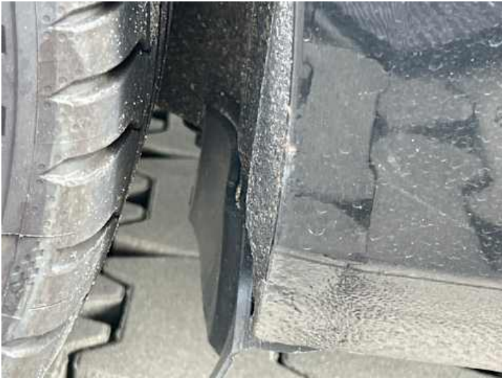
Schweller rechts (Rost)
