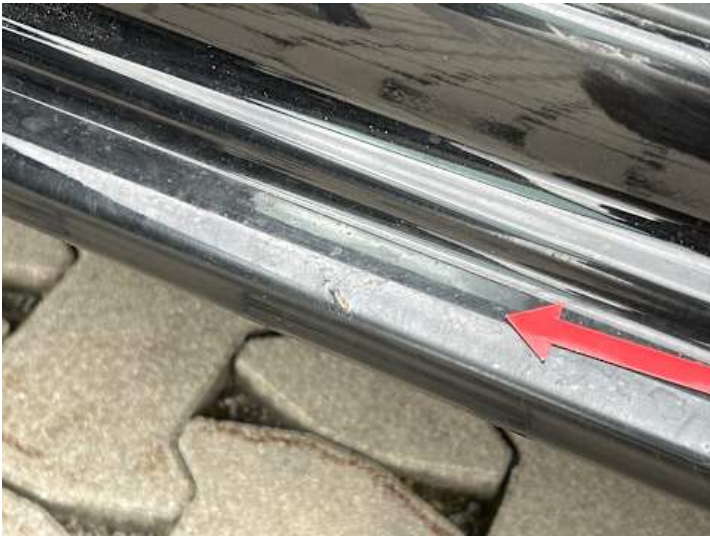
Schweller links (Rost)
