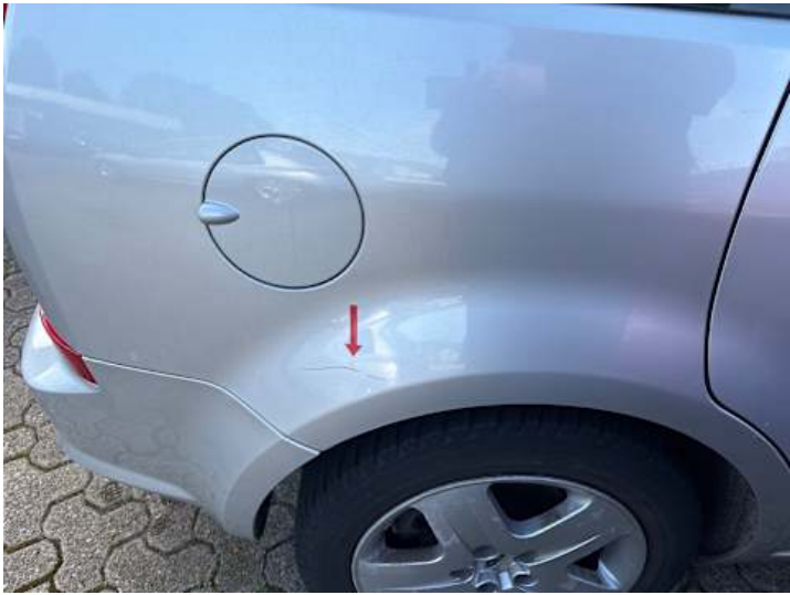
Seitenteil hinten rechts (Kratzer)
