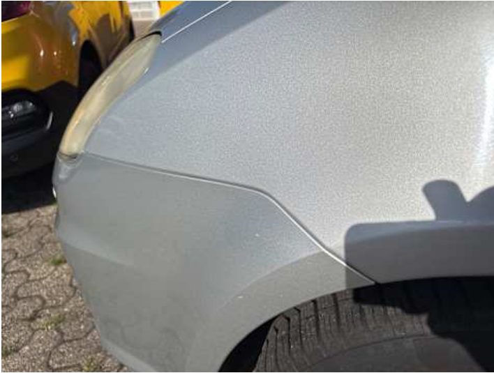
Stoßstange vorne (Anderer Schaden): Farbunterschied
