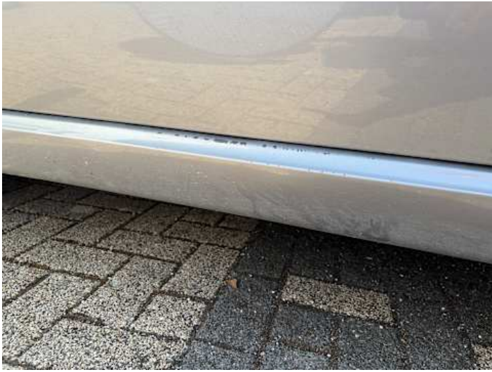
Schweller links (Lackschaden, Kratzer)
