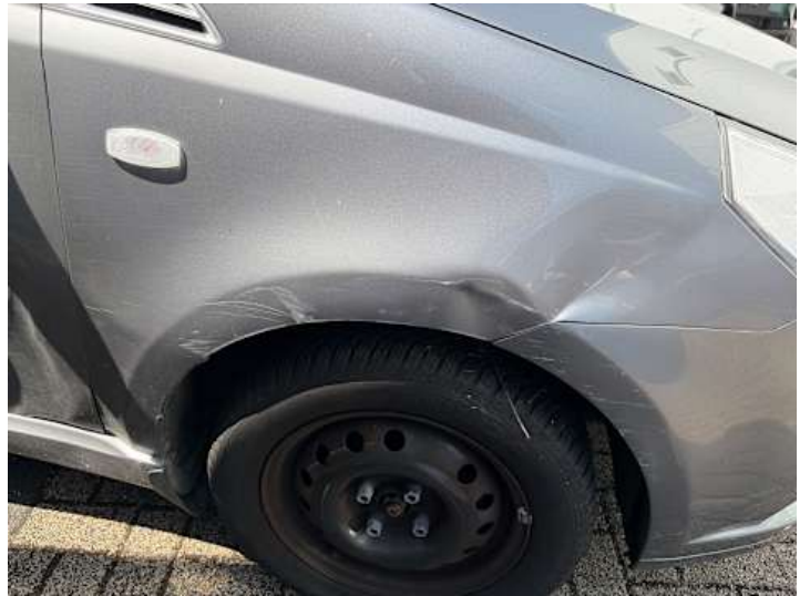
Kotflügel vorne rechts (Lackschaden, Kratzer, Verformung, Delle)
