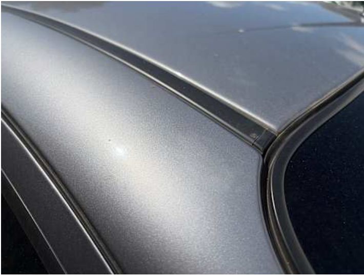
Dach (Lackschaden, Kratzer)
