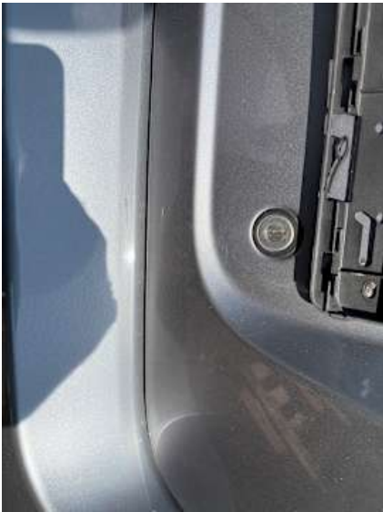
Heckklappe (Lackschaden, Kratzer)
