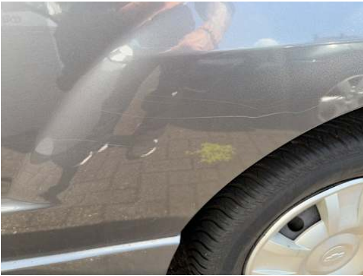
Seitenteil hinten links (Lackschaden, Kratzer)
