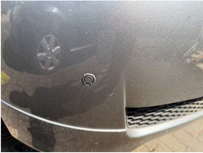
Stoßstange hinten (Riss/Bruch)
