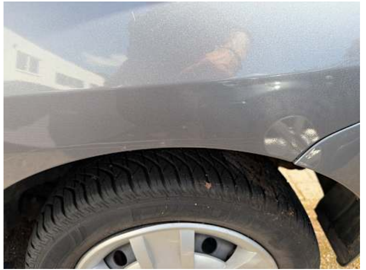
Seitenteil hinten links (Lackschaden, Kratzer)
