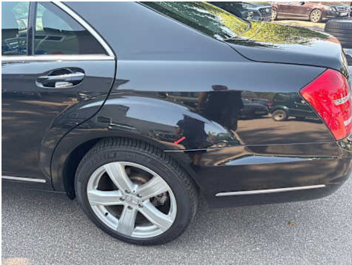
Stoßstange hinten (Spaltmaße ungenau)
