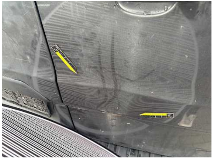
Heckklappe (Verformung, Kratzer)
