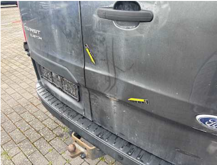
Heckklappe (Verformung, Kratzer)
