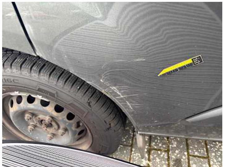
Fahrtür (Kratzer, Verformung)
