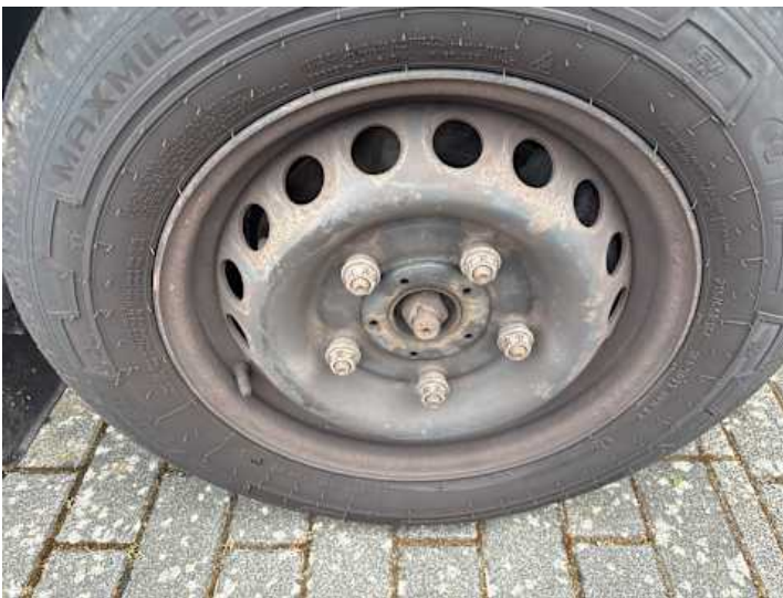
Rad (Anderer Schaden): Alle Felgen korrodiert
