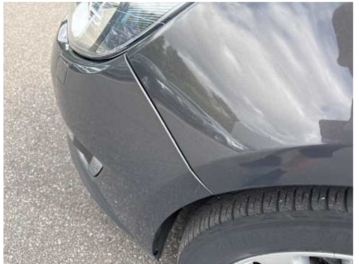
Stoßstange vorne (Spaltmaße ungenau)
