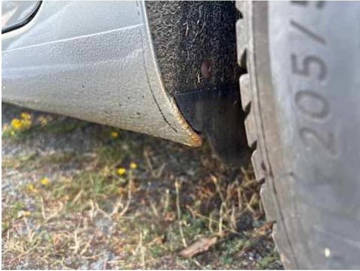
Schweller links (Rost)
