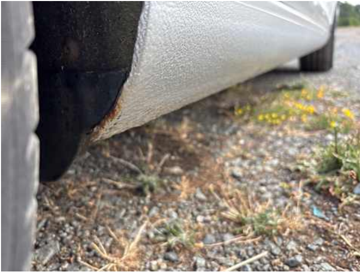
Schweller rechts (Rost)
