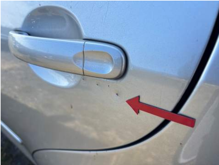
Türe hinten links (Kratzer)
