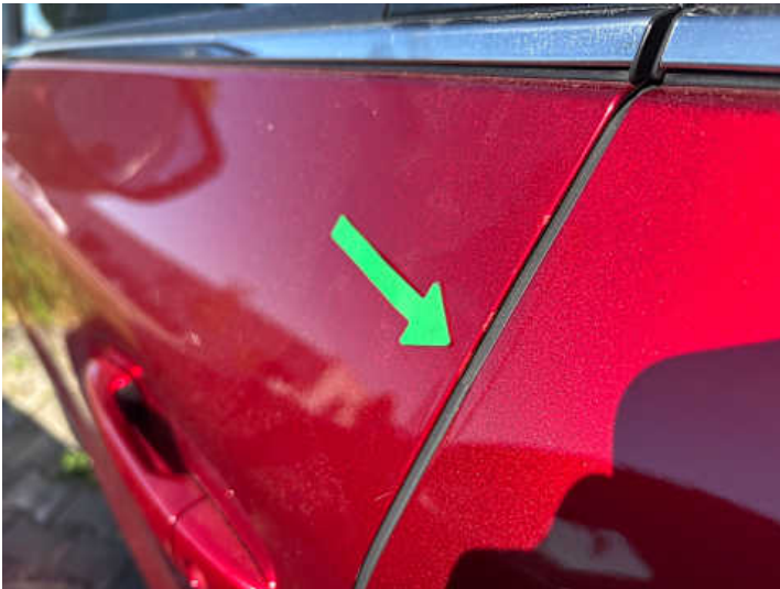
Fahrertür (Kratzer, Unsachgemäß instand gesetzt)
