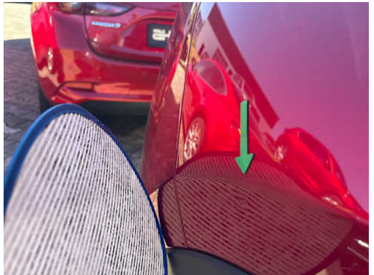
Seitenteil hinten rechts (Delle)
