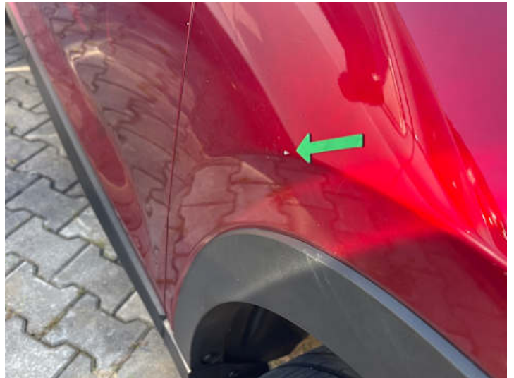
Kotflügel vorne rechts (Steinschlag)
