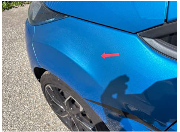
Kotflügel vorne links (Unsachgemäß instand gesetzt, Ausgeblichen/Matt)
