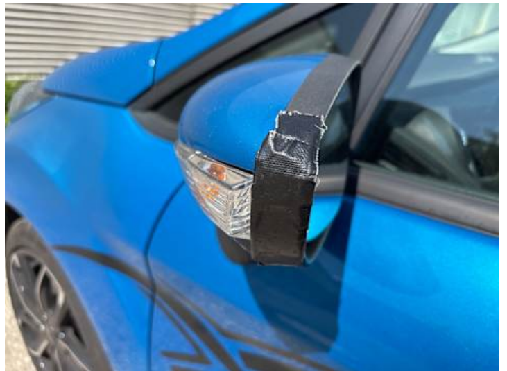
Fahrtür (Riss/Bruch, Unsachgemäß instand gesetzt)
