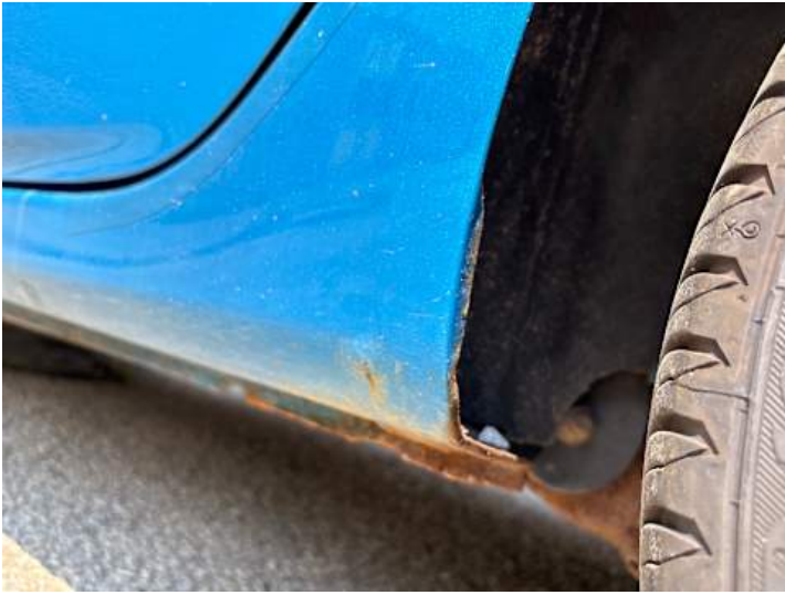
Schweller links (Rost)
