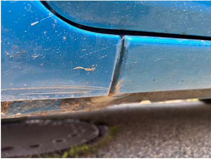
Schweller links (Verformung)
