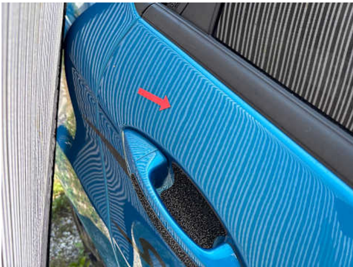
Türe hinten rechts (Delle)
