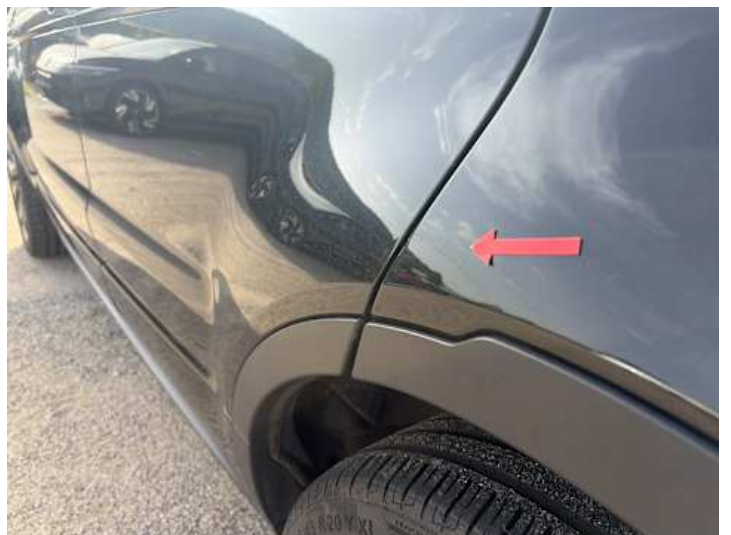
Seitenteil hinten links (Lackschaden)
