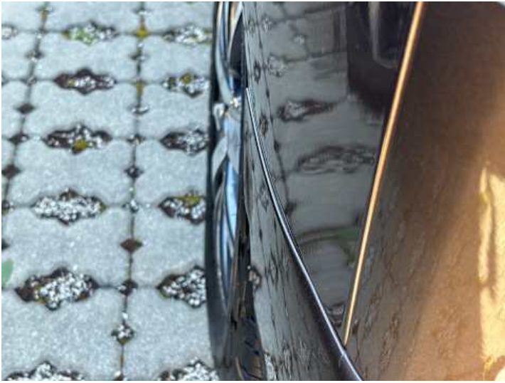
Stoßstange hinten (Spaltmaße ungenau)
