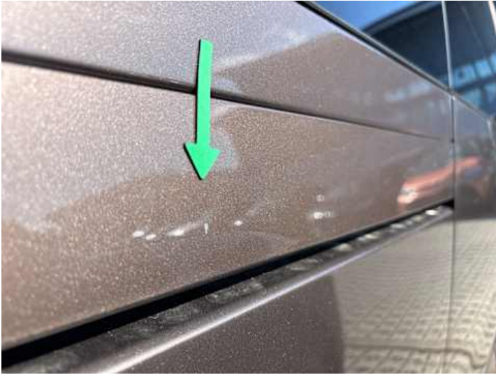
Seitenteil hinten rechts (Kratzer)
