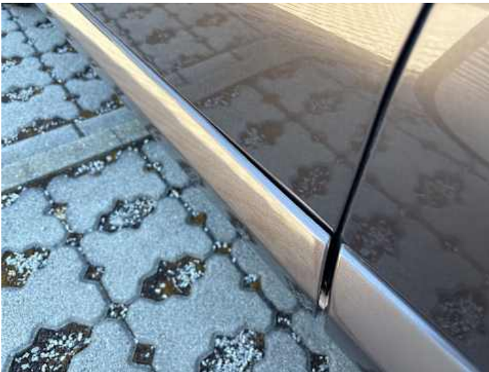
Fahrtür (Spaltmaße ungenau)
