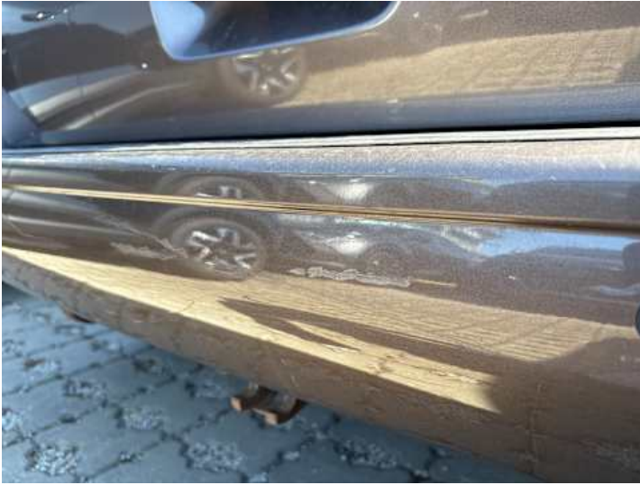
Stoßstange hinten (Kratzer)
