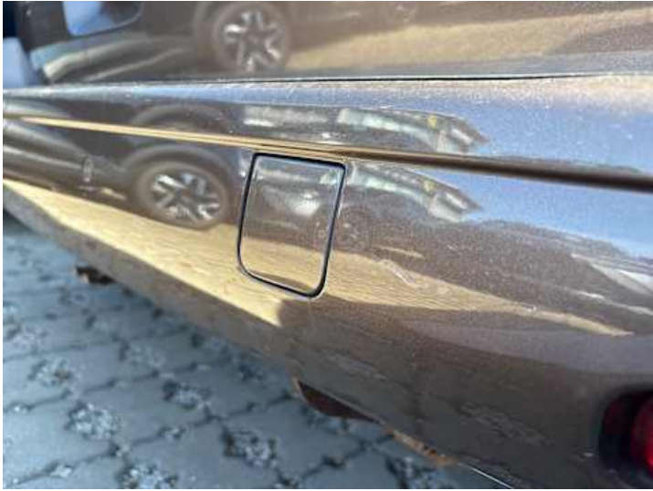
Stoßstange hinten (Kratzer)
