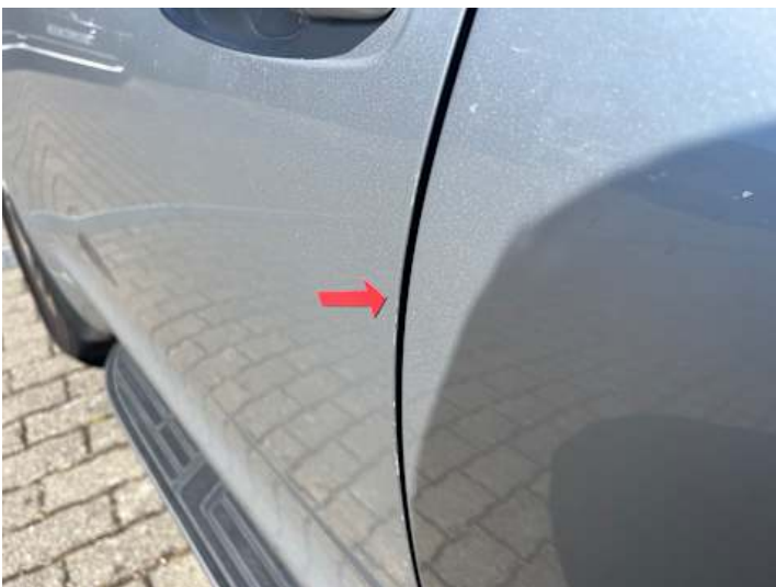
Fahrtür (Lackschaden, Rost)
