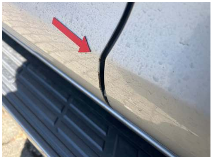
Fahrtür (Lackschaden, Rost)
