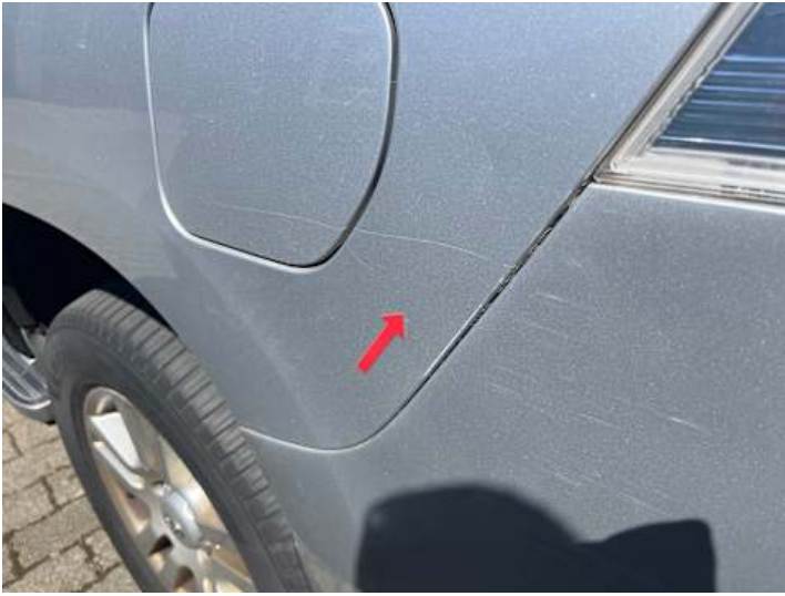
Seitenteil hinten links (Lackschaden, Kratzer)
