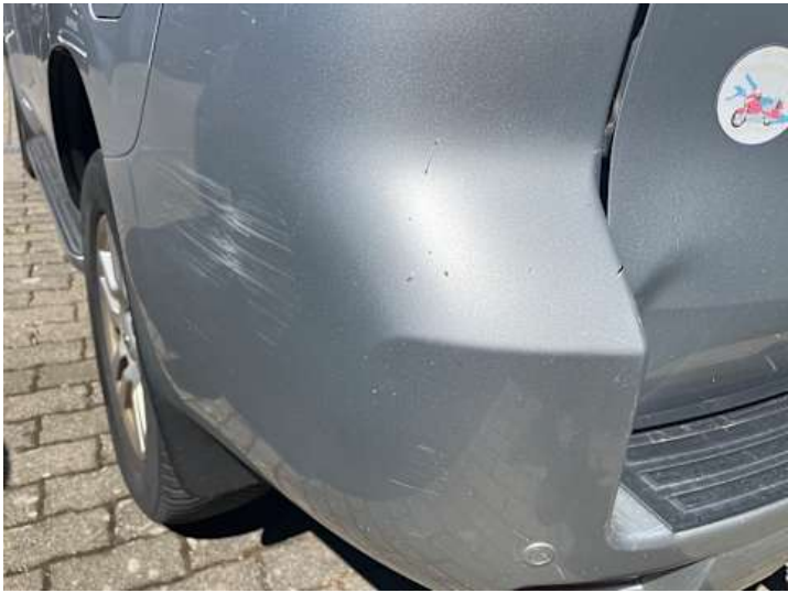
Stoßstange hinten (Lackschaden, Kratzer)
