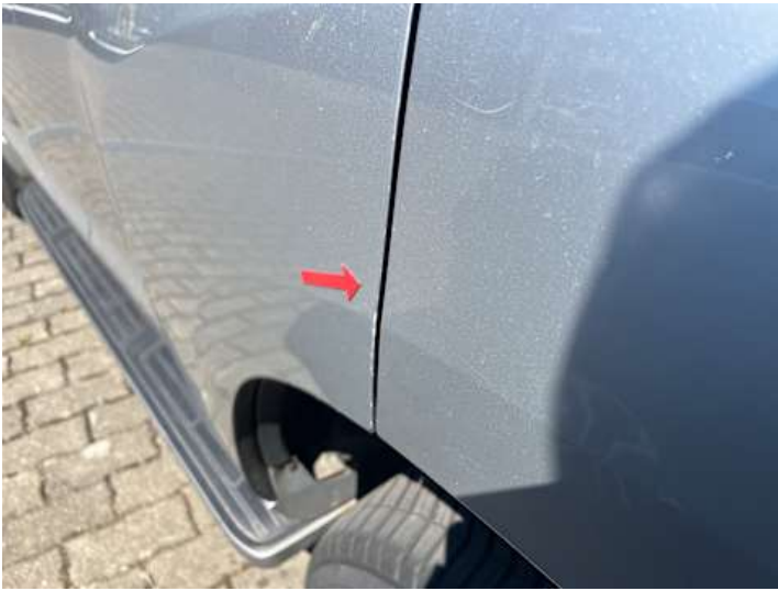
Türe hinten links (Lackschaden, Kratzer)
