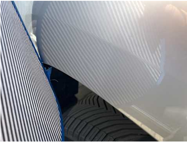
Seitenteil hinten rechts (Delle)
