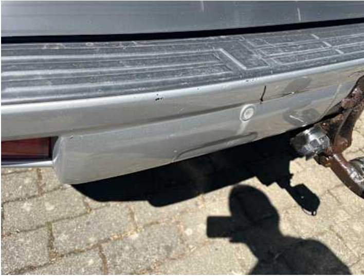
Stoßstange hinten (Lackschaden, Kratzer)
