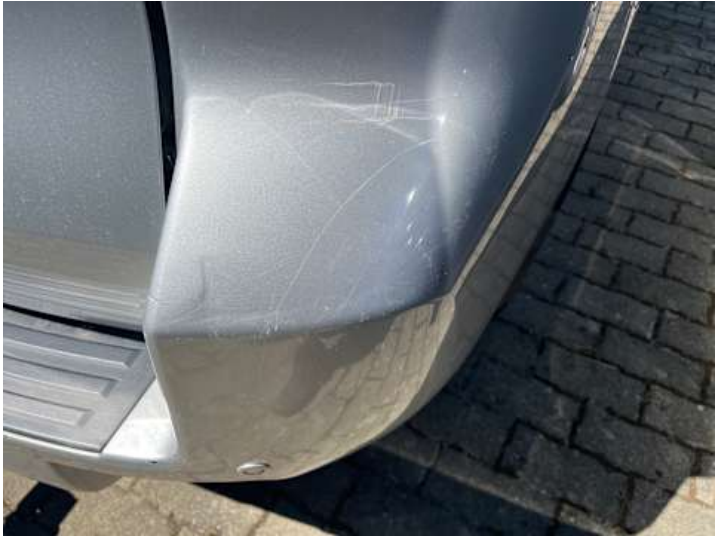
Stoßstange hinten (Lackschaden, Kratzer)
