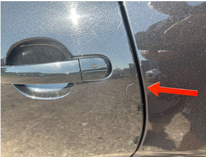
Türe hinten links (Kratzer)
