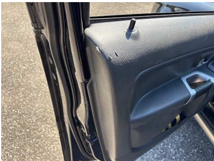
Innenraum (Riss/Bruch, Verschleiß, Kratzer)
