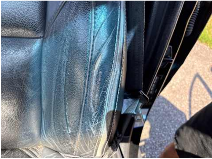
Innenraum (Riss/Bruch, Verschleiß, Kratzer)
