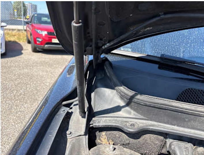
Motorhaube (Anderer Schaden): Dämpfer ohne Funktion
