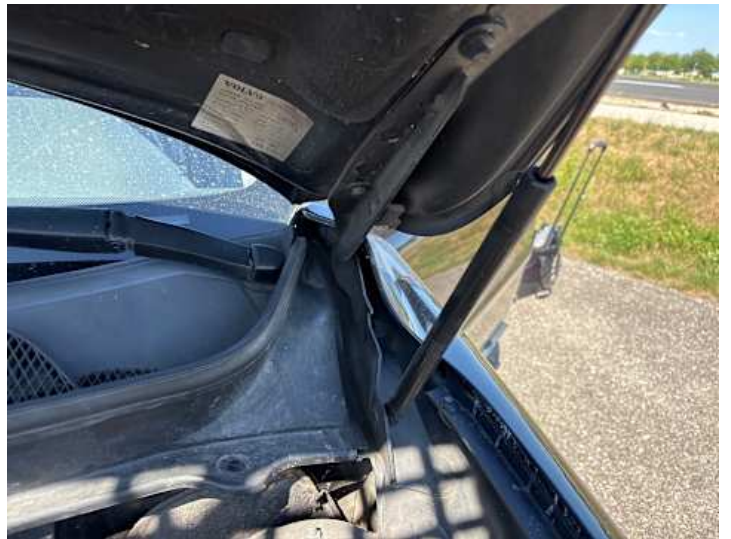
Motorhaube (Anderer Schaden): Dämpfer ohne Funktion
