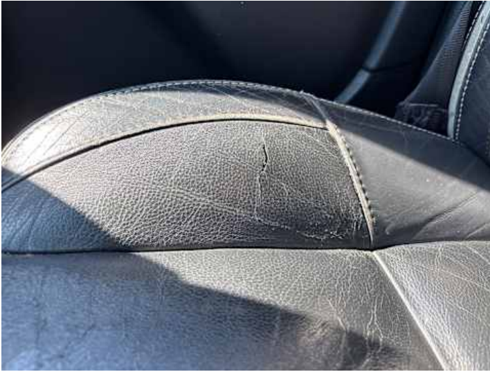
Innenraum (Riss/Bruch, Verschleiß, Kratzer)
