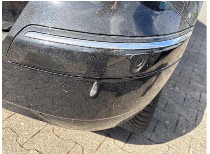
Stoßstange hinten (Kratzer, Spaltmaße ungenau)
