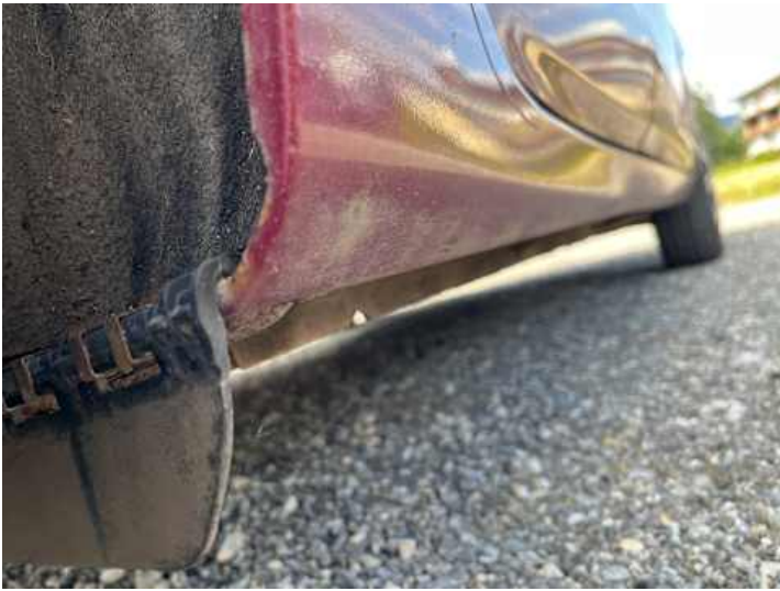
Schweller rechts (Rost)
