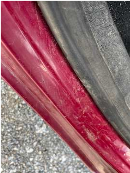
Schweller rechts (Kratzer)
