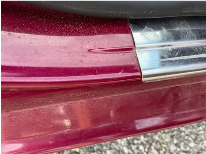
Schweller rechts (Kratzer)
