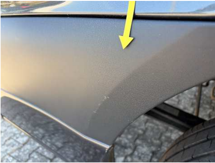
Seitenteil hinten rechts (Kratzer)
