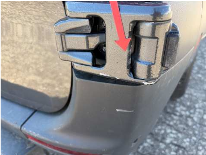
Stoßstange hinten (Kratzer, Riss/Bruch)
