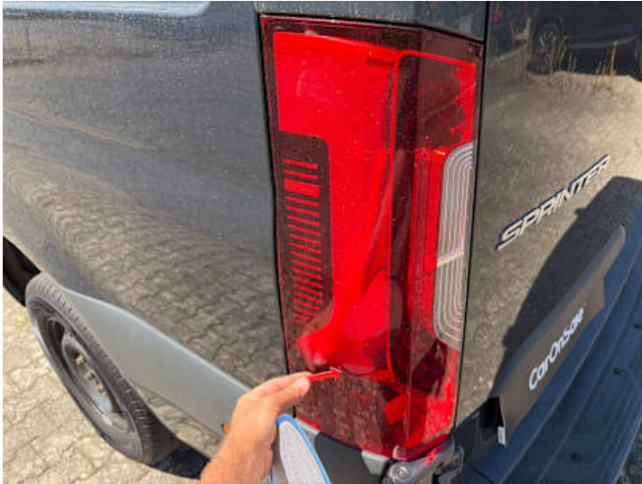
Rücklicht (links) (Kratzer)
