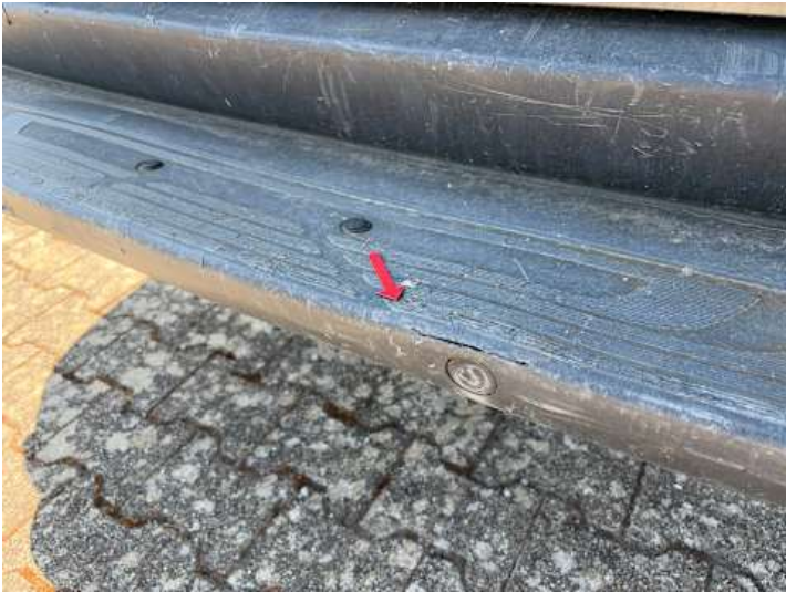
Stoßstange hinten (Kratzer, Riss/Bruch)
