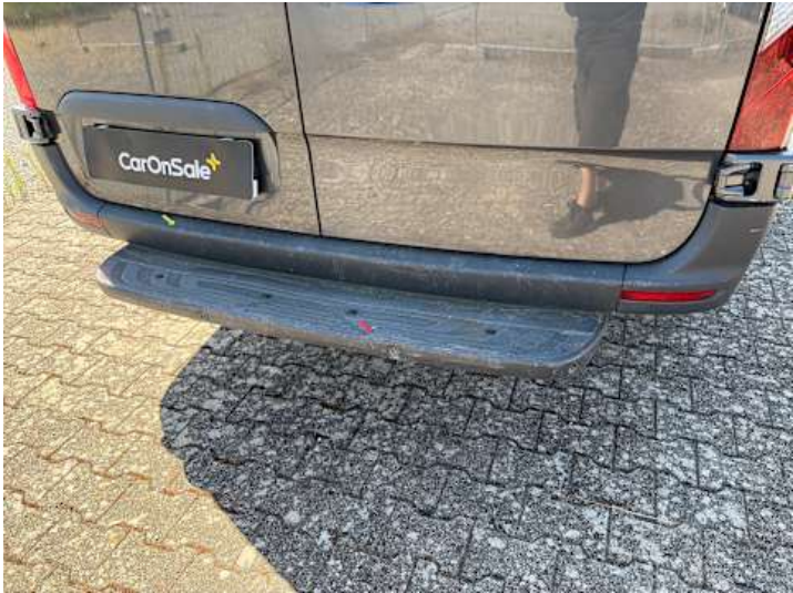
Stoßstange hinten (Kratzer, Riss/Bruch)
