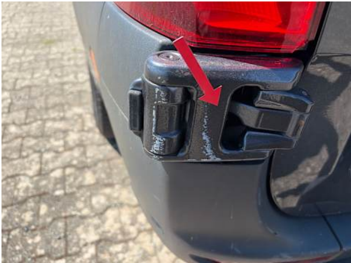
Stoßstange hinten (Kratzer, Riss/Bruch)
