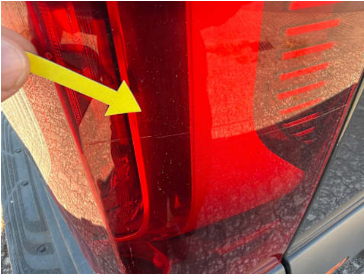
Rücklicht (rechts) (Kratzer)
