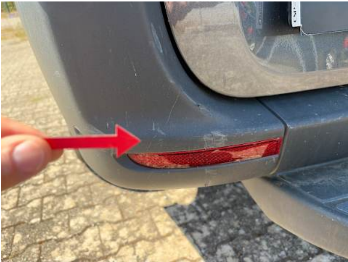
Stoßstange hinten (Kratzer, Riss/Bruch)
