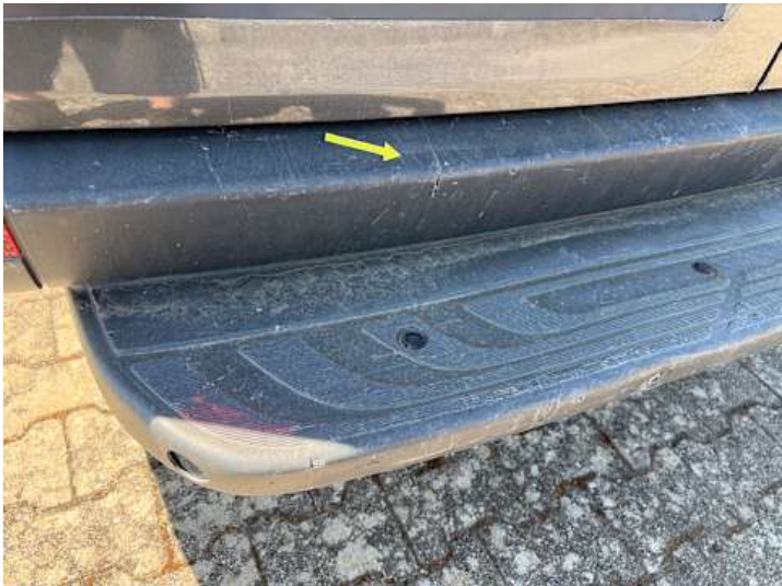
Stoßstange hinten (Kratzer, Riss/Bruch)
