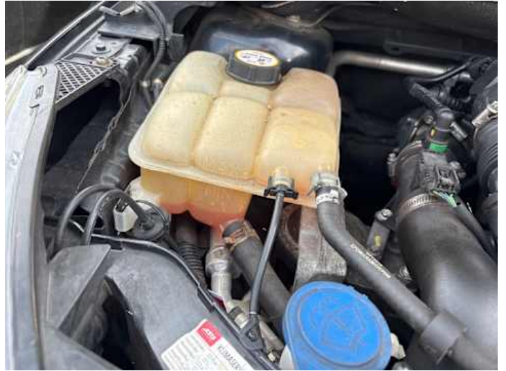
Motorhaube (Anderer Schaden): Kühlmittelstand zu gering,
