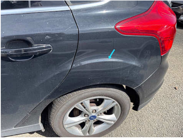
Seitenteil hinten links (Kratzer)
