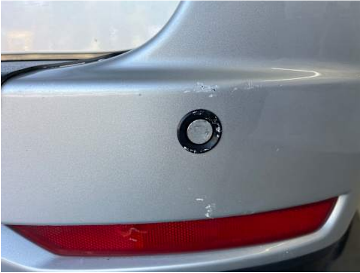
Stoßstange hinten (Kratzer, Lackschaden, Riss/Bruch)
