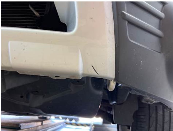
Stoßstange vorne (Kratzer, Lackschaden)
