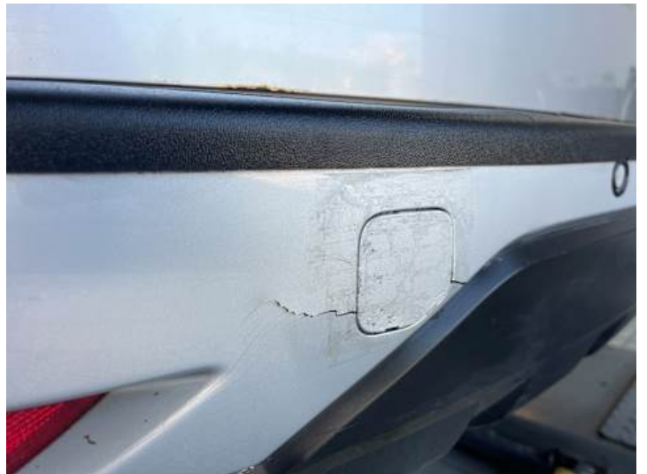
Stoßstange hinten (Kratzer, Lackschaden, Riss/Bruch)
