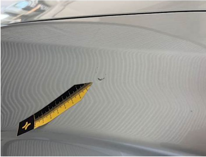
Kotflügel vorne links (Kratzer, Lackschaden, Delle)
