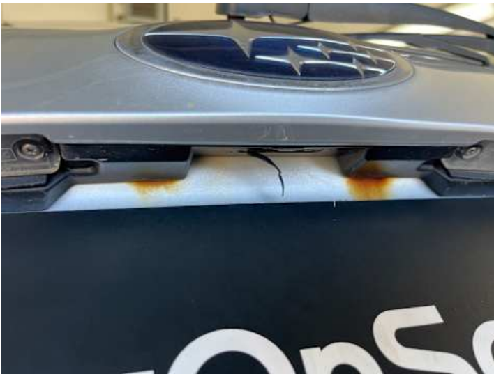
Heckklappe (Rost, Lackschaden)
