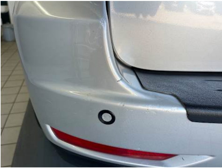
Stoßstange hinten (Kratzer, Lackschaden, Riss/Bruch)
