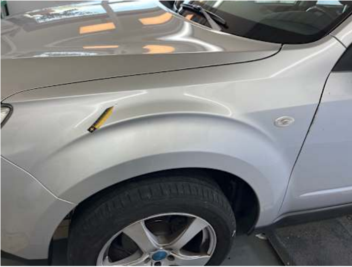
Kotflügel vorne links (Kratzer, Lackschaden, Delle)
