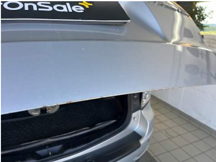
Heckklappe (Rost, Lackschaden)
