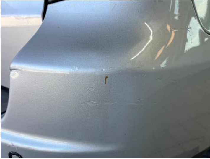
Stoßstange hinten (Kratzer, Lackschaden, Riss/Bruch)
