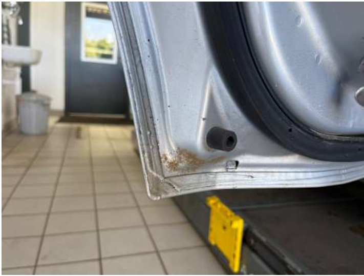
Türe hinten links (Rost, Lackschaden)
