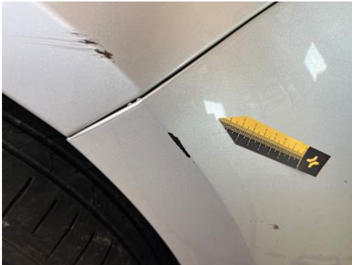
Stoßstange vorne (Kratzer, Lackschaden, Spaltmaße ungenau)
