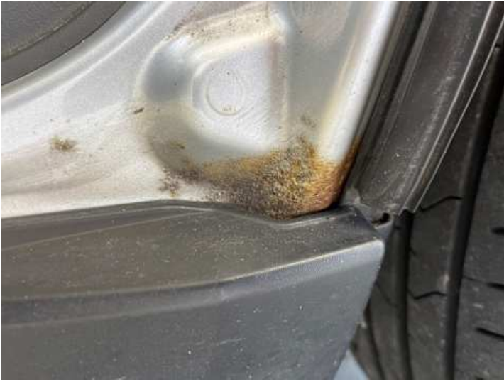
Schweller links (Rost, Lackschaden)
