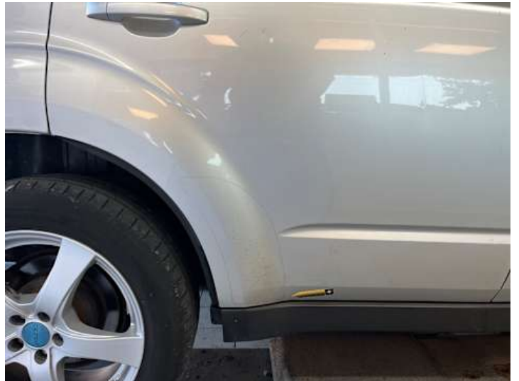
Türe hinten rechts (Lackschaden, Rost, Kratzer)
