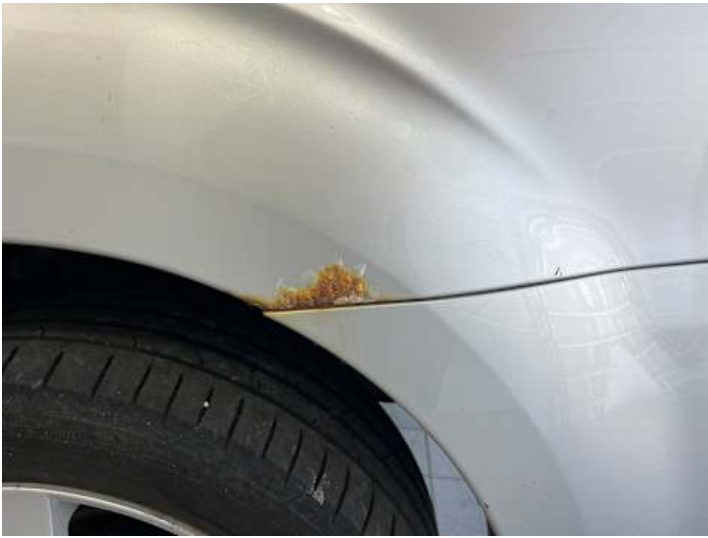
Seitenteil hinten links (Rost, Lackschaden)
