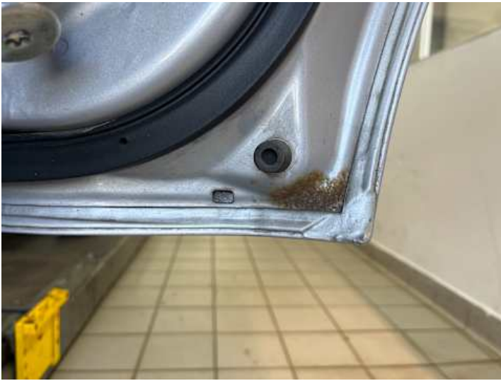
Türe hinten rechts (Rost, Lackschaden)
