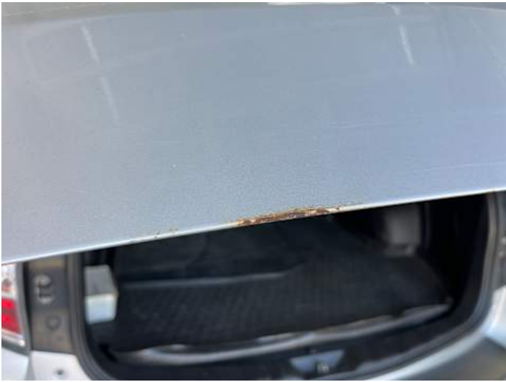
Heckklappe (Rost, Lackschaden)
