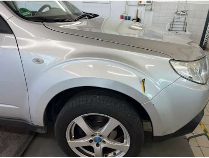
Kotflügel vorne rechts (Kratzer, Lackschaden)
