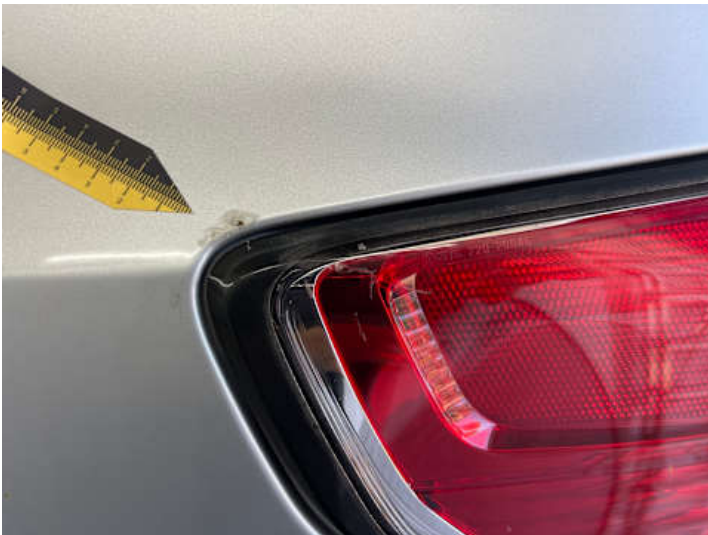
Rücklicht (links) (Kratzer)
