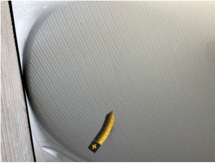
Türe hinten rechts (Verformung)
