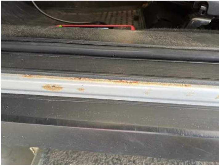
Schweller links (Rost, Lackschaden)
