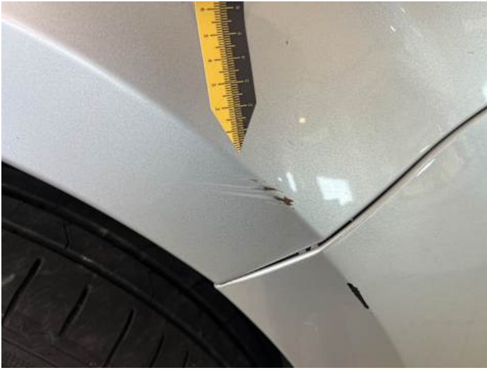
Kotflügel vorne rechts (Kratzer, Lackschaden)
