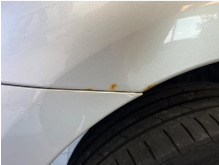
Seitenteil hinten rechts (Rost, Lackschaden)
