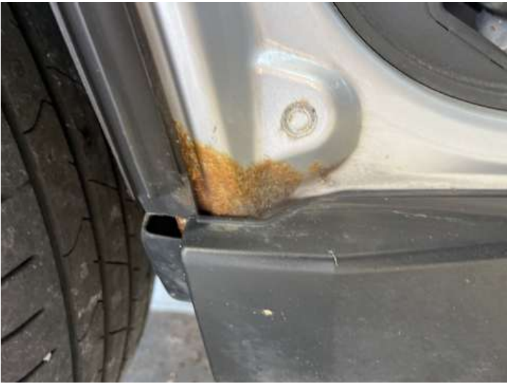
Schweller rechts (Rost, Lackschaden)
