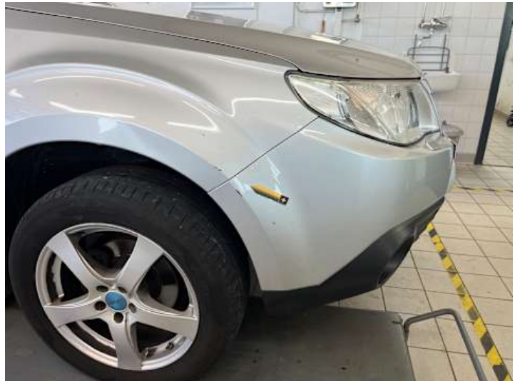
Stoßstange vorne (Kratzer, Lackschaden, Spaltmaße ungenau)
