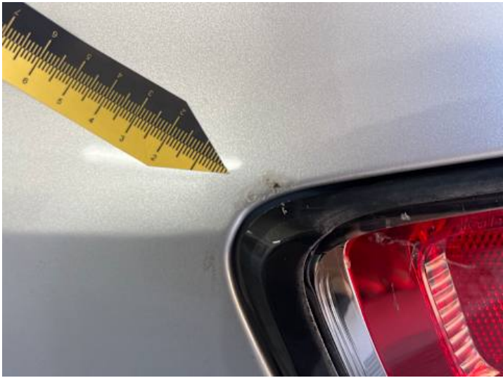
Seitenteil hinten links (Lackschaden, Unsachgemäß instand gesetzt)
