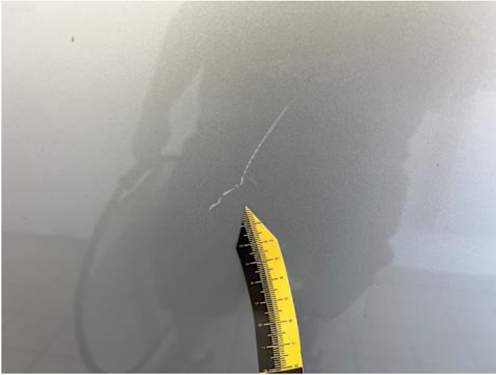
Türe hinten links (Kratzer)
