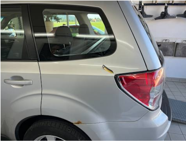
Seitenteil hinten links (Lackschaden, Unsachgemäß instand gesetzt)
