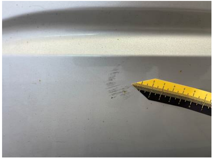
Türe hinten rechts (Lackschaden, Rost, Kratzer)
