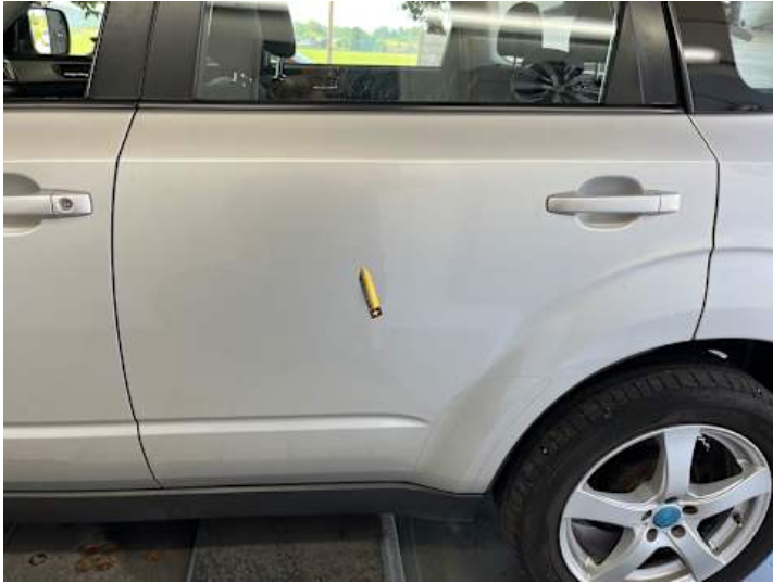
Türe hinten links (Kratzer)
