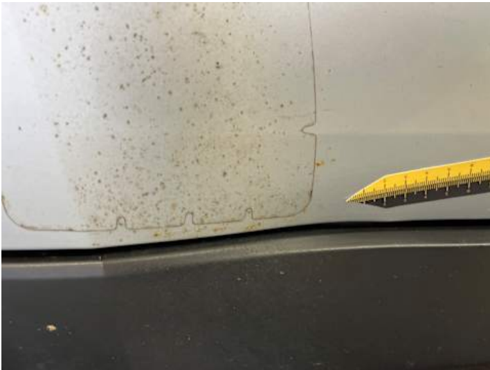
Türe hinten rechts (Lackschaden, Rost, Kratzer)
