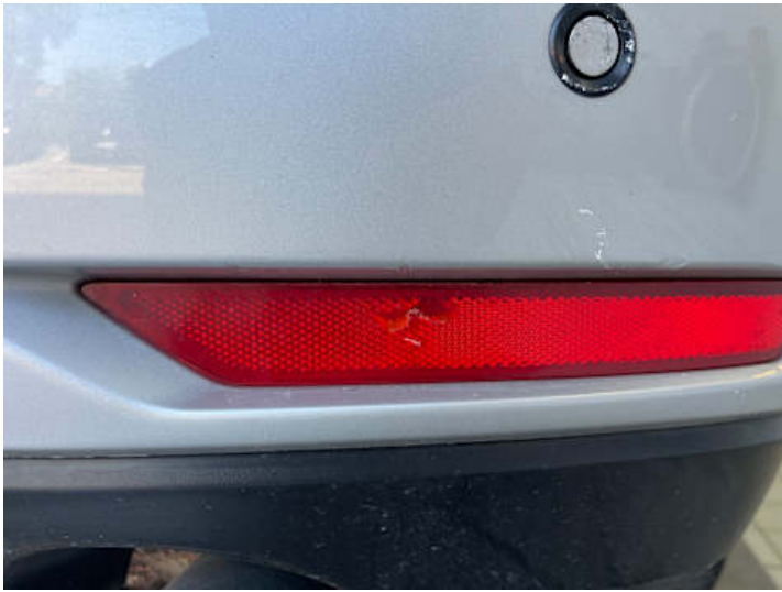
Stoßstange hinten (Kratzer, Lackschaden, Riss/Bruch)
