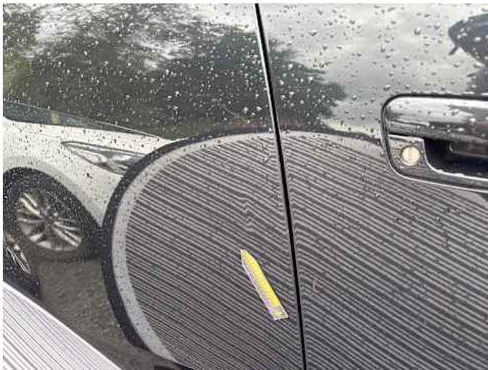
Türe hinten rechts (Delle, Lackschaden)
