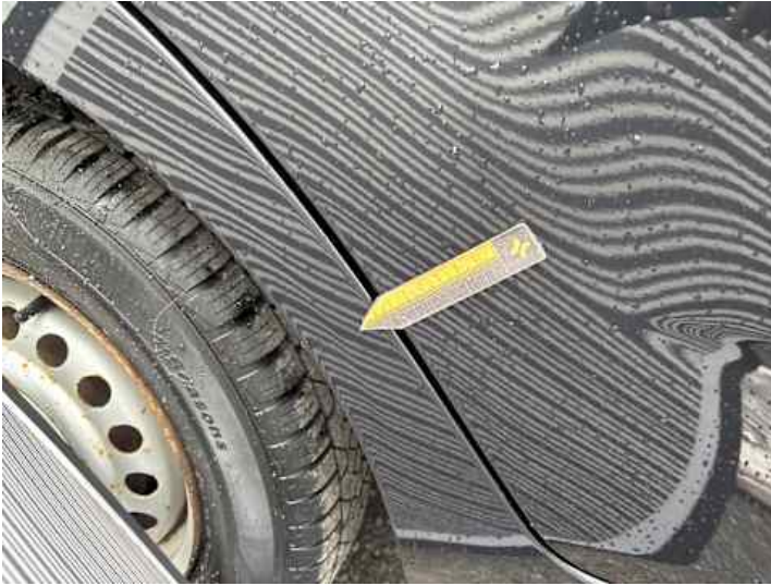
Seitenteil hinten rechts (Lackschaden)
