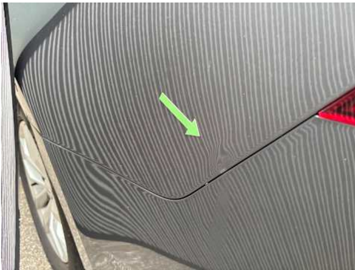
Seitenteil hinten links (Delle, Rost)
