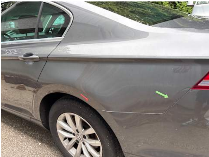
Seitenteil hinten links (Delle, Rost)
