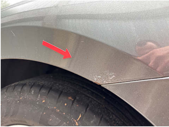
Seitenteil hinten links (Delle, Rost)
