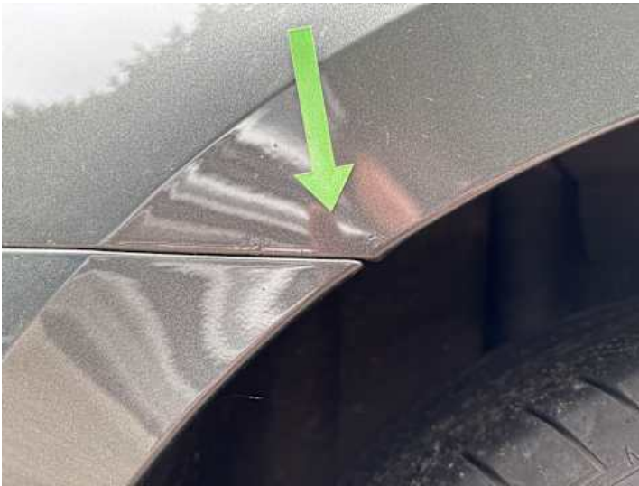
Seitenteil hinten rechts (Rost)
