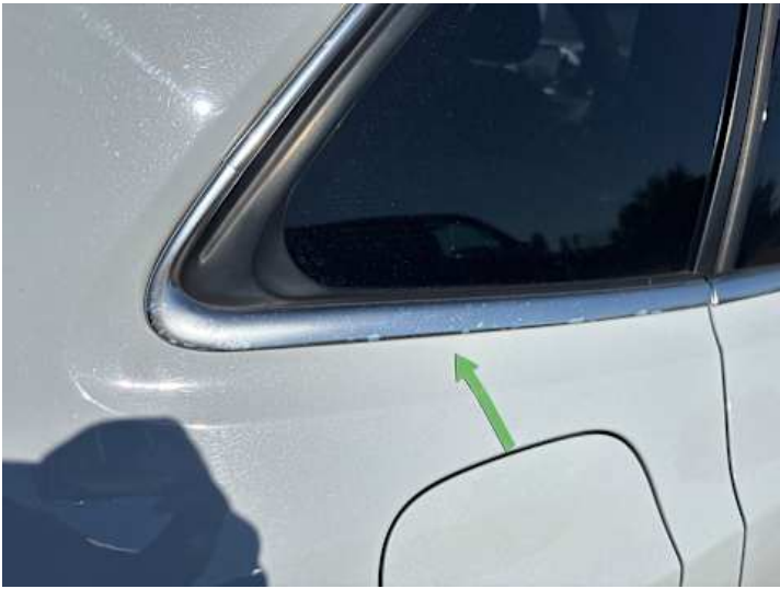
Seitenteil hinten rechts (Anderer Schaden): Verfärbungen
