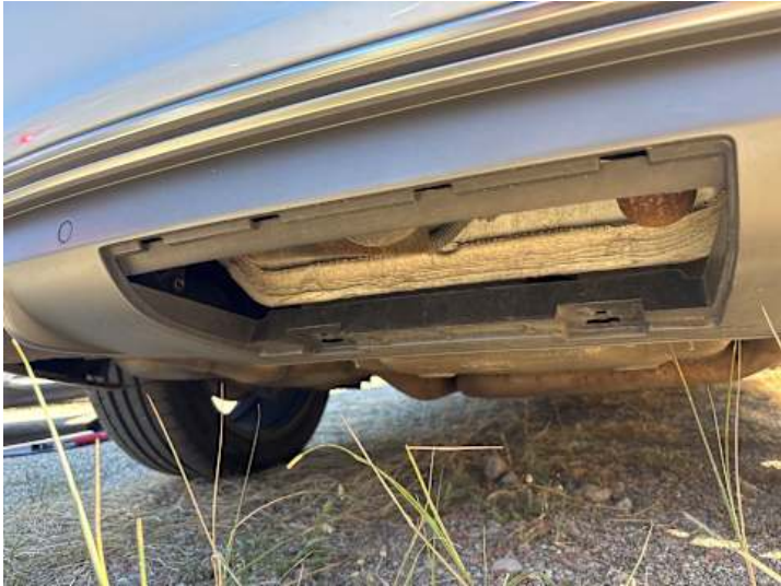
Stoßstange hinten (Anderer Schaden): Abdeckung fehlt
