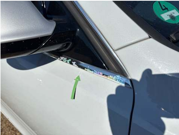
Beifahrertür (Anderer Schaden): Leisten verfärbt
