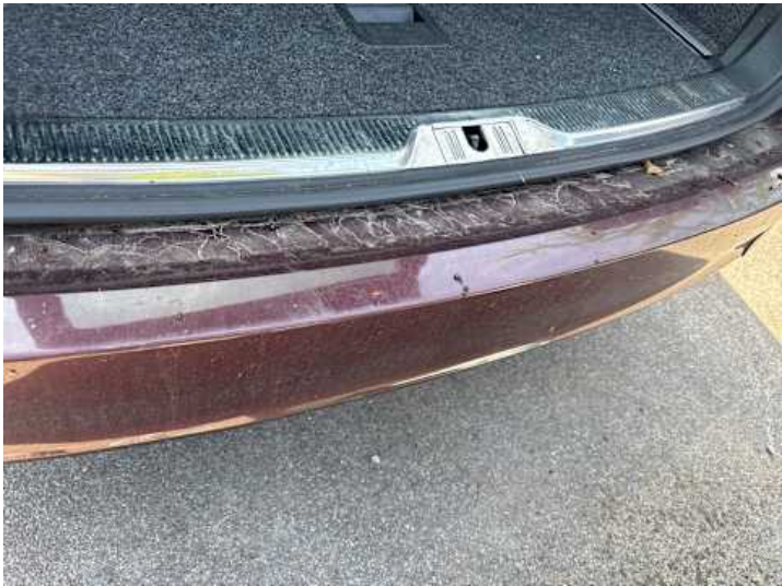
Stoßstange hinten (Kratzer, Verformung)
