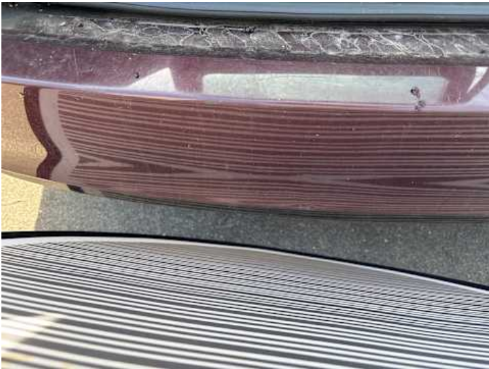
Stoßstange hinten (Kratzer, Verformung)
