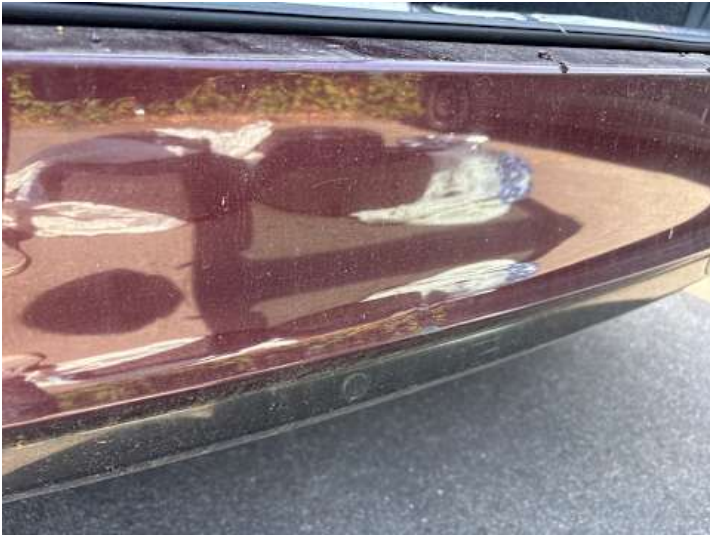
Stoßstange hinten (Kratzer, Verformung)
