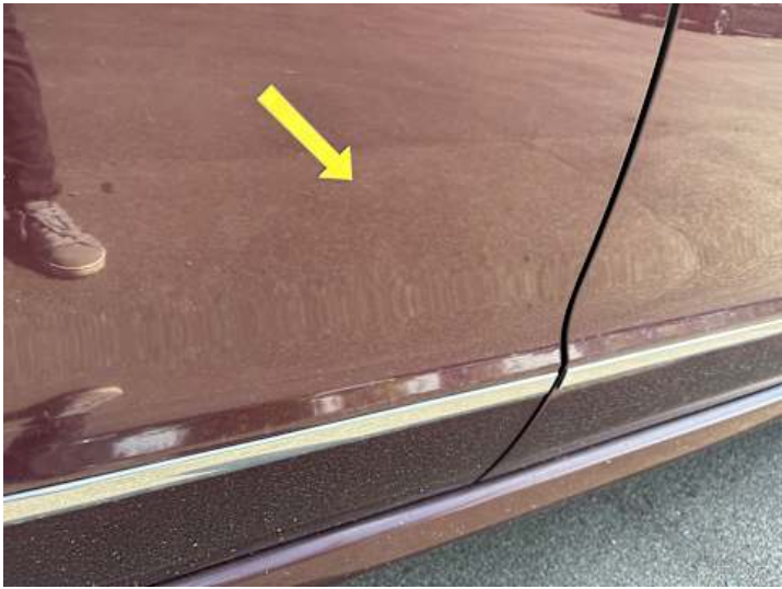
Türe hinten rechts (Kratzer)
