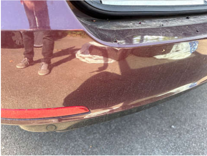
Stoßstange hinten (Kratzer, Verformung)
