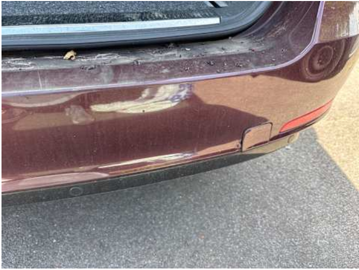
Stoßstange hinten (Kratzer, Verformung)
