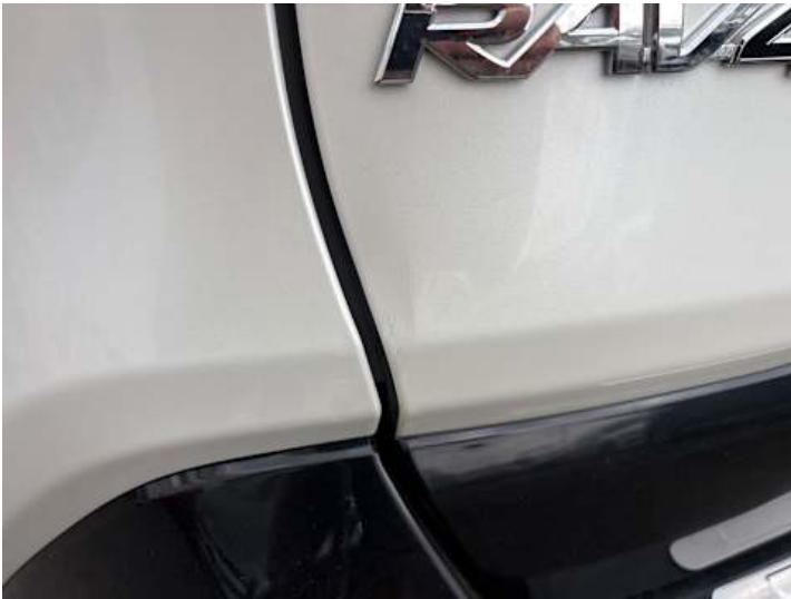
Heckklappe (Kratzer, Lackschaden)
