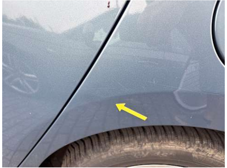
Seitenteil hinten links (Delle, Kratzer)
