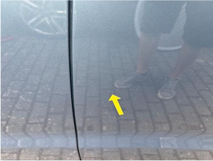
Türe hinten links (Kratzer)
