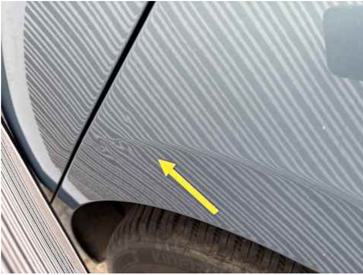
Seitenteil hinten links (Delle, Kratzer)
