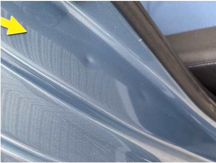
Seitenteil hinten rechts (Delle)
