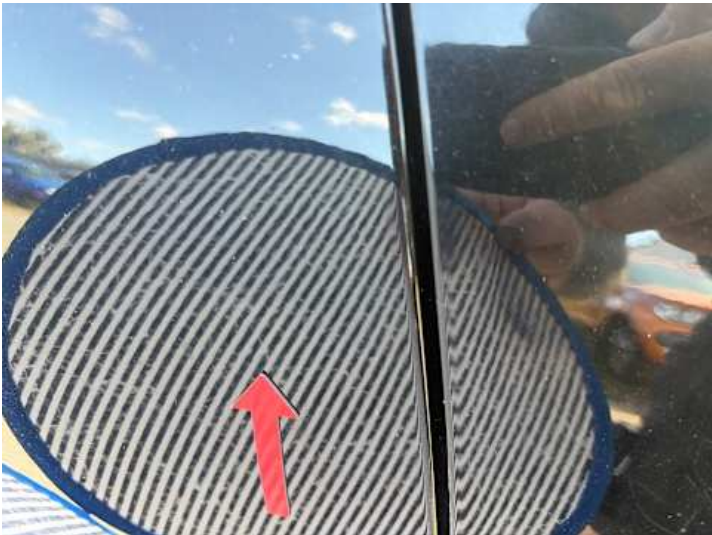
Türe hinten rechts (Delle, Kratzer, Lackschaden)
