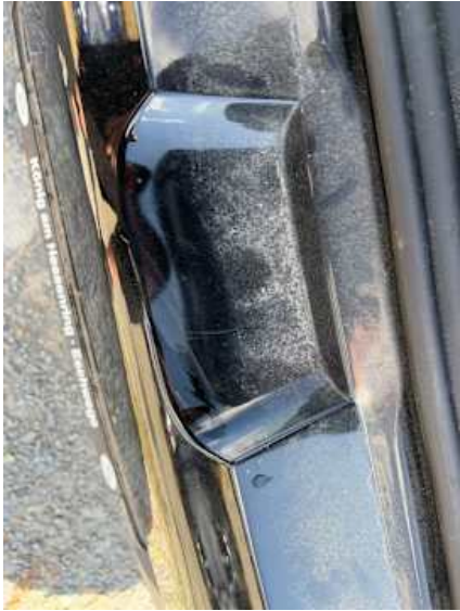
Stoßstange hinten (Kratzer)
