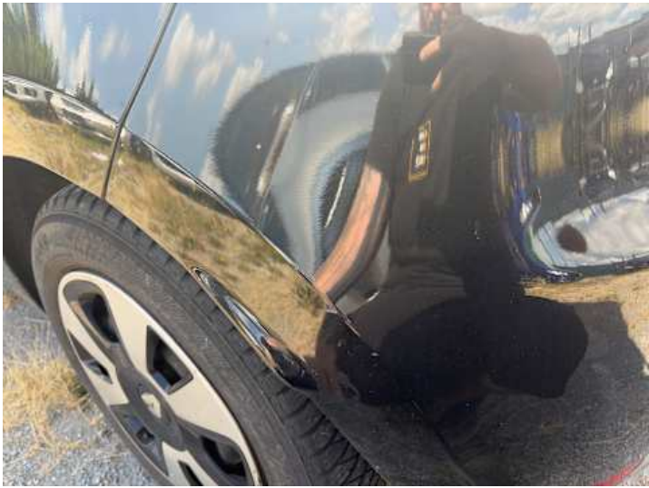
Stoßstange hinten (Kratzer, Lackschaden, Verformung)
