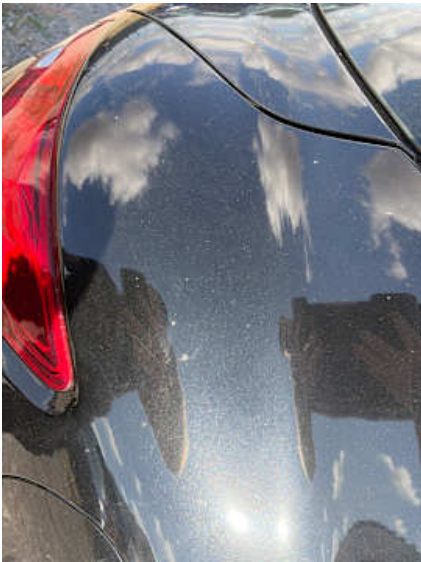
Seitenteil hinten rechts (Kratzer, Lackschaden)
