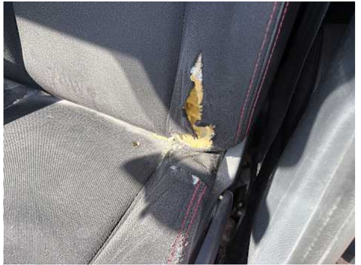
Innenraum (Riss/Bruch, Brandloch)
