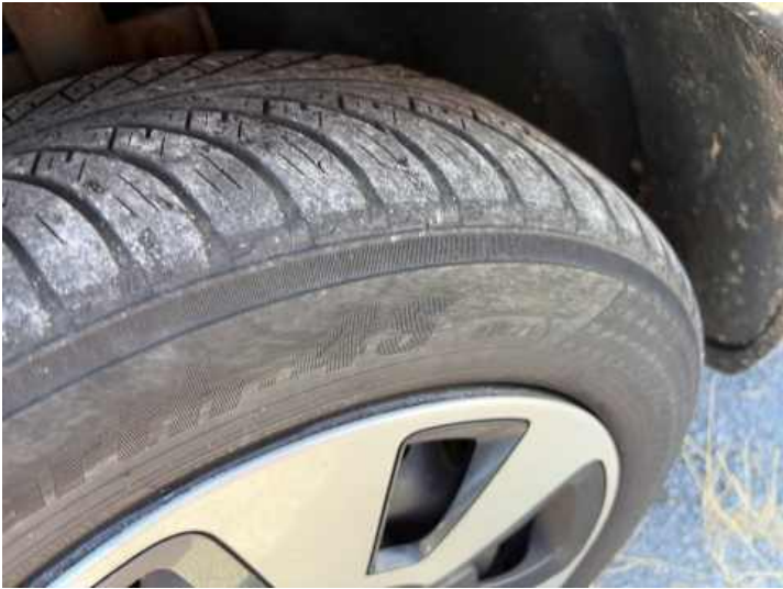
Rad (Ungleichmäßig abgefahren)
