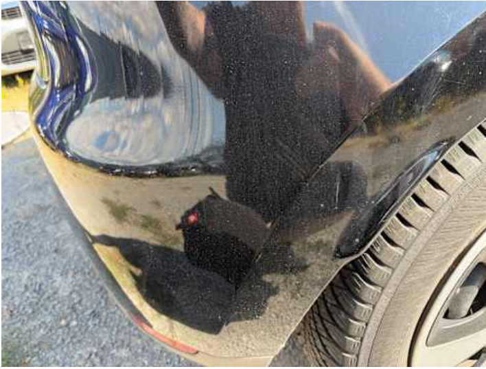
Stoßstange hinten (Kratzer)
