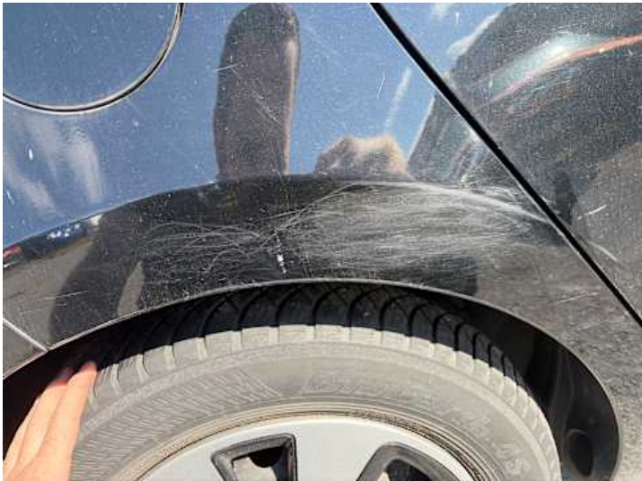
Seitenteil hinten rechts (Kratzer, Lackschaden)
