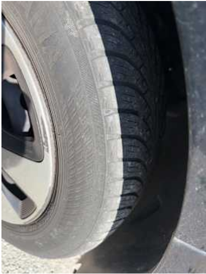
Rad (Ungleichmäßig abgefahren)
