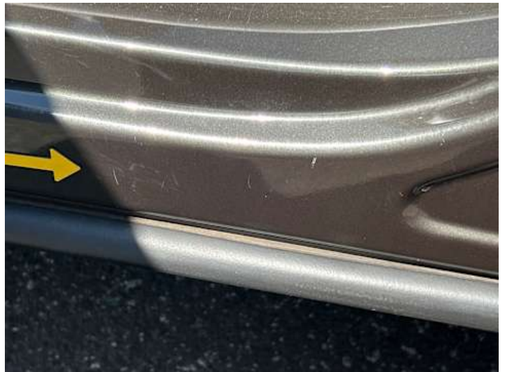
Schweller links (Kratzer)
