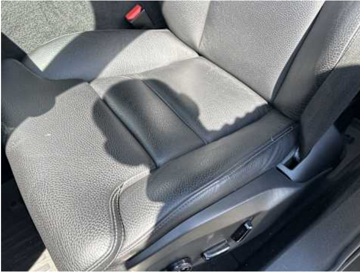
Innenraum (Riss/Bruch, Verschleiß)
