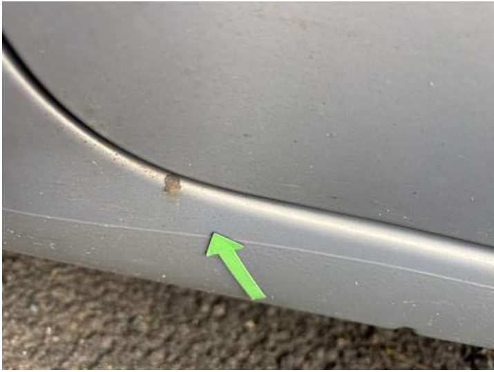
Schweller rechts (Lackschaden)
