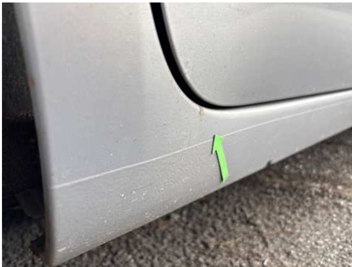
Schweller rechts (Lackschaden)
