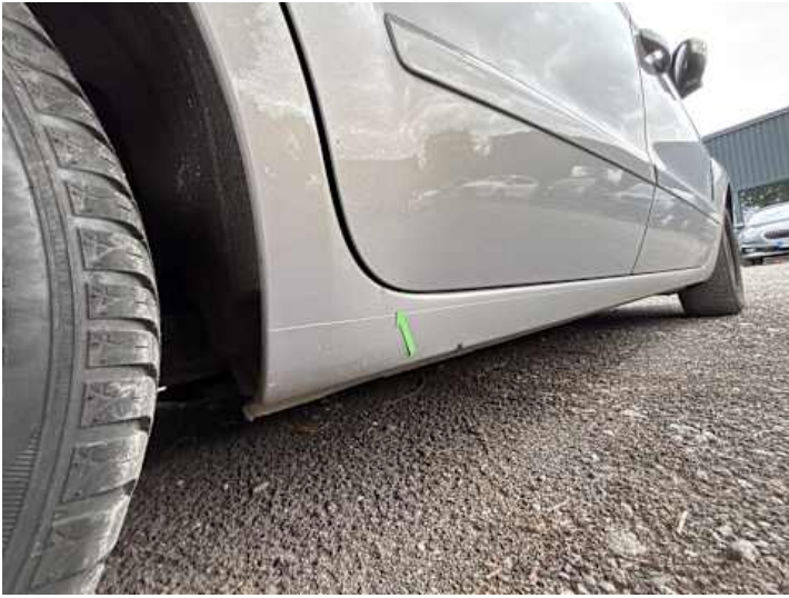
Schweller rechts (Lackschaden)
