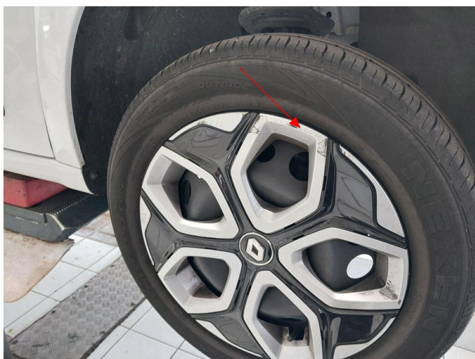
Bild 1: Außen, Felge vorne rechts - Radzierdeckel, verschrammt, erneuern
