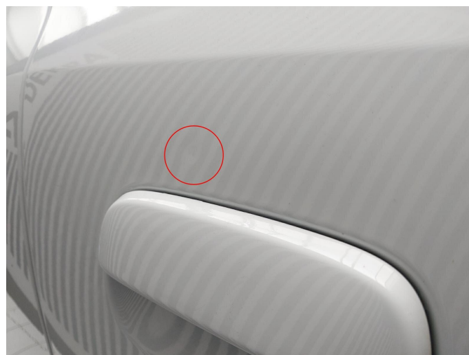
Bild 2: Außen, Tür vorne rechts - beim Türgriff, eingedellt, smart repair
