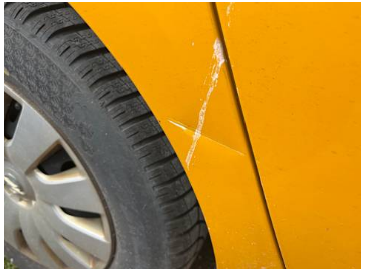
Seitenteil hinten rechts (Lackschaden, Kratzer, Delle)
