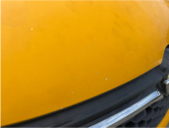
Motorhaube (Lackschaden, Steinschlag)
