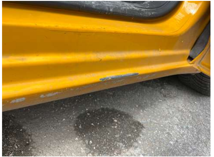
Schweller rechts (Lackschaden, Verformung)
