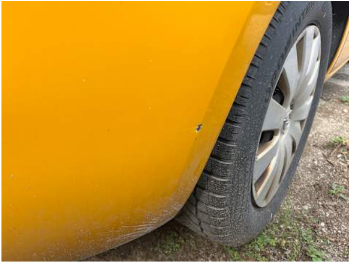
Stoßstange hinten (Lackschaden, Kratzer)
