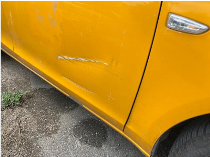
Beifahrertür (Lackschaden, Kratzer, Verformung)
