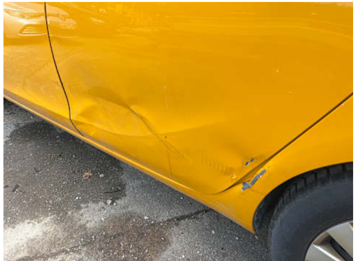
Türe hinten links (Lackschaden, Kratzer, Verformung)
