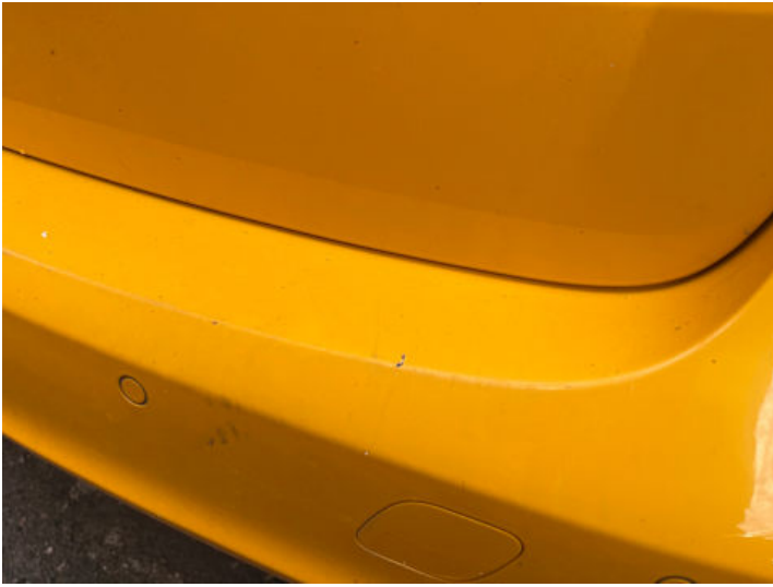
Stoßstange hinten (Lackschaden, Kratzer)
