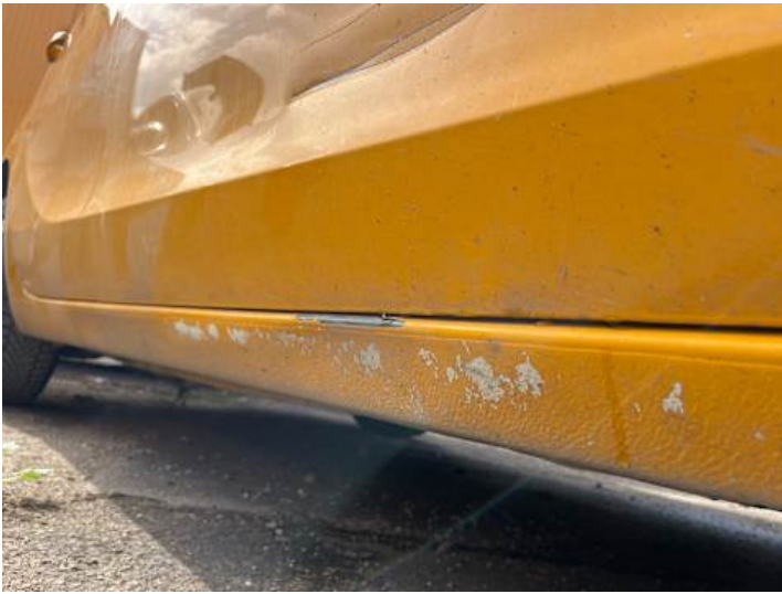
Schweller rechts (Lackschaden, Verformung)
