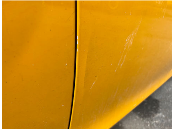
Beifahrertür (Lackschaden, Kratzer, Verformung)
