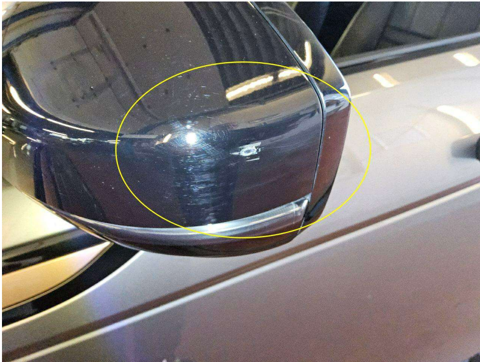
Bild 7 : Außenspiegel links, Spiegelkappe verschrammt
