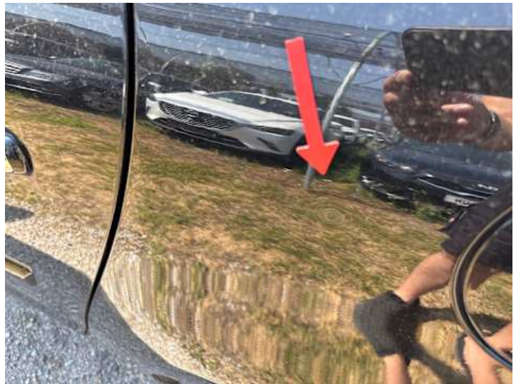
Seitenteil hinten links (Delle)
