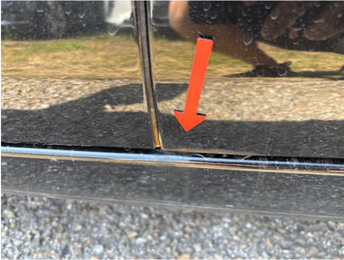
Türe hinten links (Rost)
