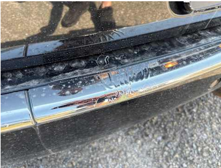
Stoßstange hinten (Kratzer, Lackschaden)
