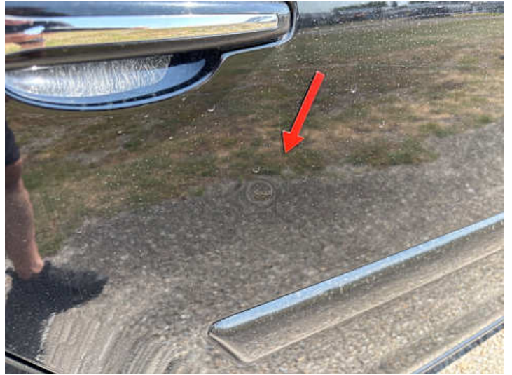
Türe hinten rechts (Delle)
