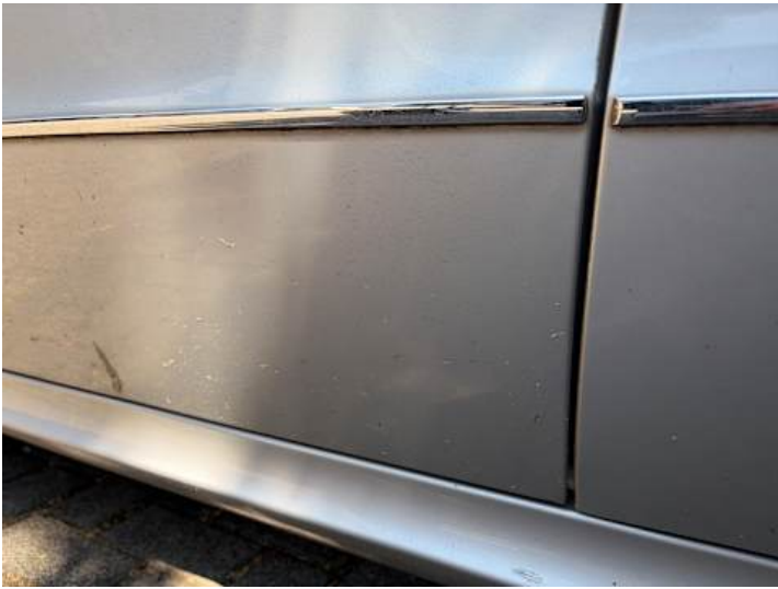
Fahrertür (Lackschaden, Kratzer)
