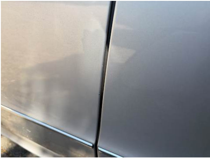
Fahrertür (Lackschaden, Kratzer)
