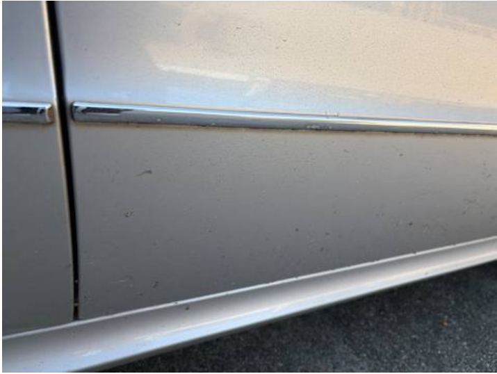
Beifahrertür (Lackschaden, Kratzer)
