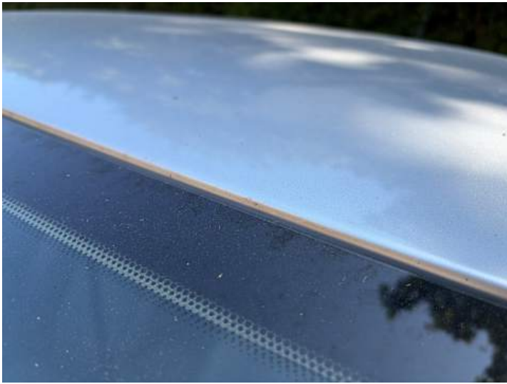
Dach (Lackschaden, Steinschlag)
