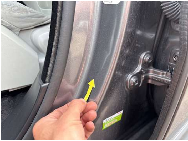
Schweller links (Delle, Kratzer)
