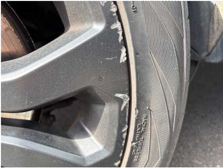
Rad (Kerben, Kratzer, Riss/Bruch)
