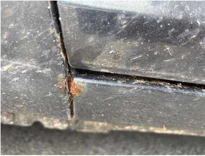
Schweller links (Rost)
