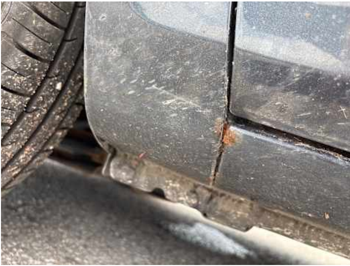
Kotflügel vorne links (Rost)
