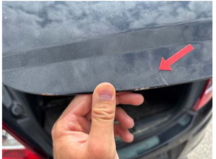
Heckklappe (Kratzer, Rost)
