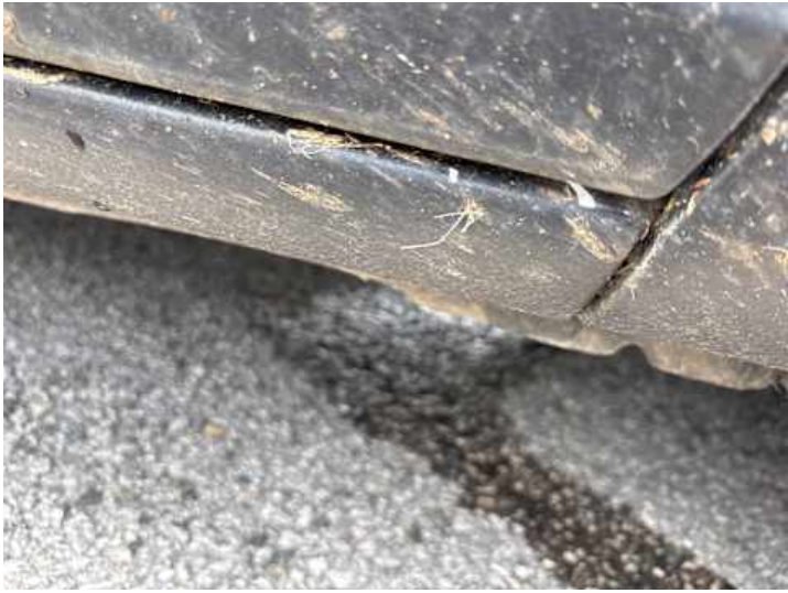
Schweller rechts (Rost)
